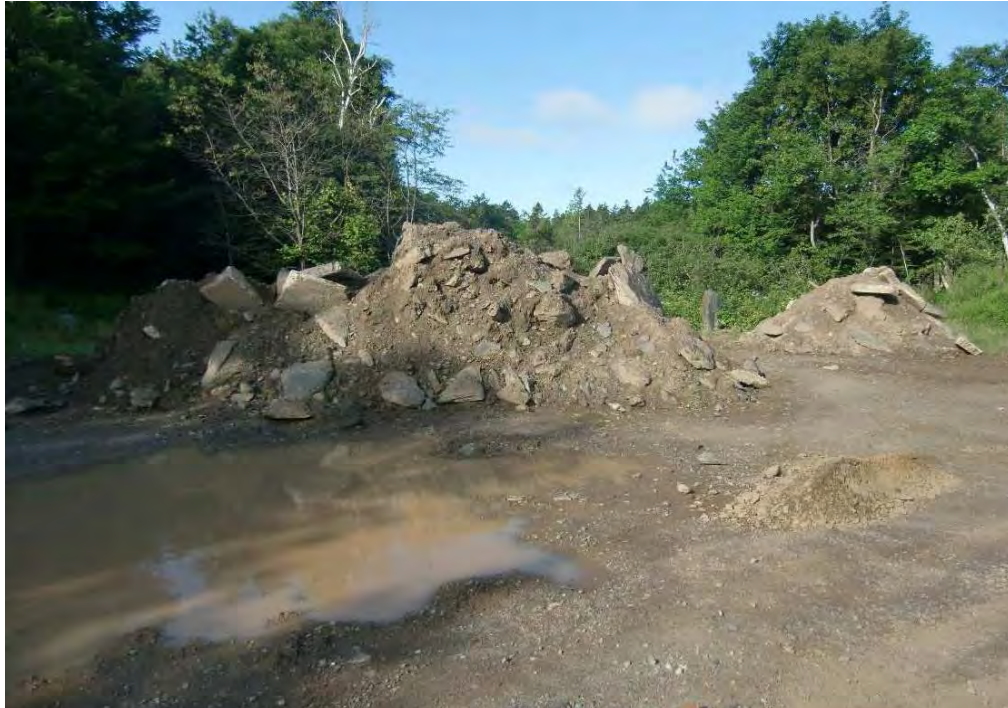
Photo 9 : Vue de l'empilement D composé de sol et de débris de béton et de briques. Vue vers l'ouest.
