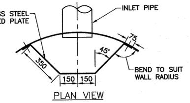
**DETAIL - INLET BAFFLE** 2
