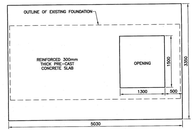
**PLAN - PRE-CAST LIFT STATION SLAB**
