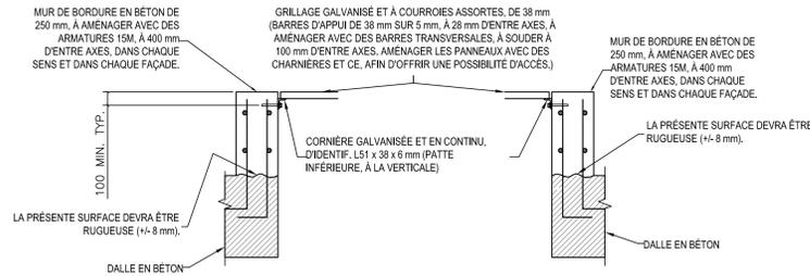
4 DÉTAIL - OUVERTURE DE LA TRAPPE D'ACCÈS À L'APPAREILLAGE
