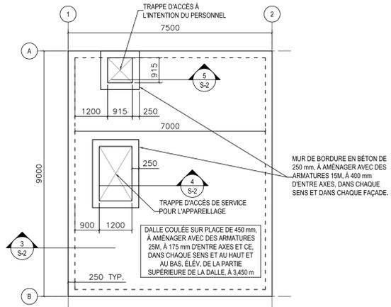
2 PLAN D'ÉTAGE AU REZ-DE-CHAUSSÉE ET (OU) PLAN DU TOIT
