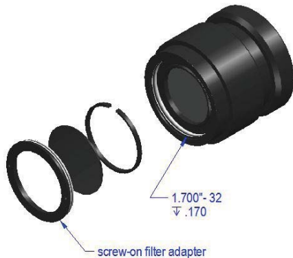
Figure 10 : Adaptateur à visser et filets intérieurs de l'objectif
