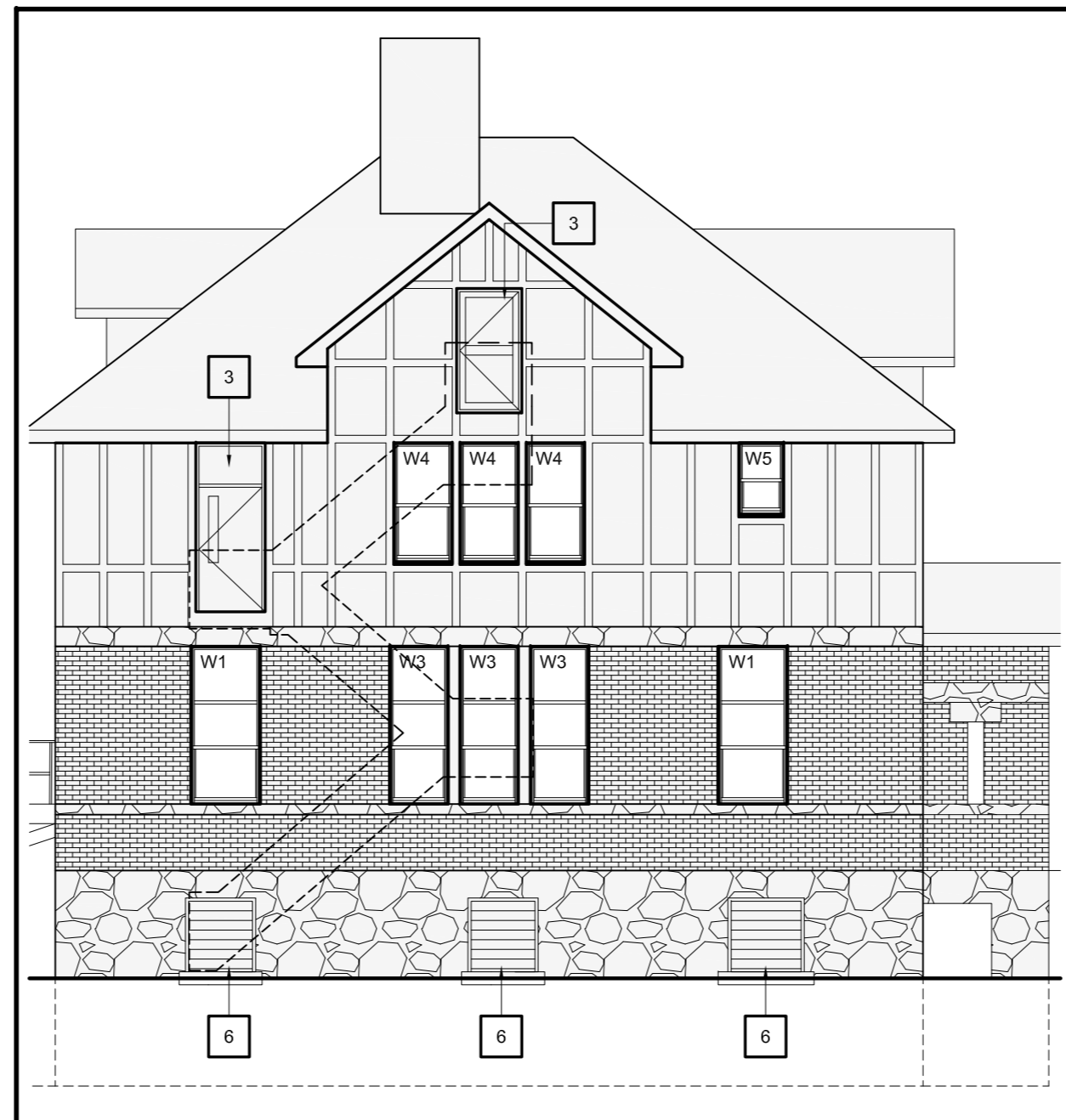
1 SOUTH ELEVATION / ÉLÉVATION SUD A200 SCALE / ÉCHELLE 1:100
