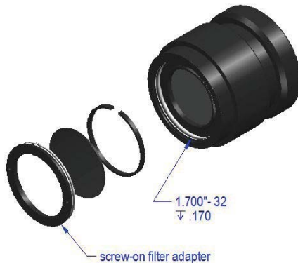
Figure 10 : Adaptateur à visser et filets intérieurs de l'objectif
