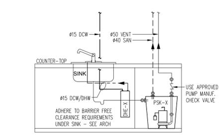
**4 PSK / DHE PIPING SCHEMATIC**
