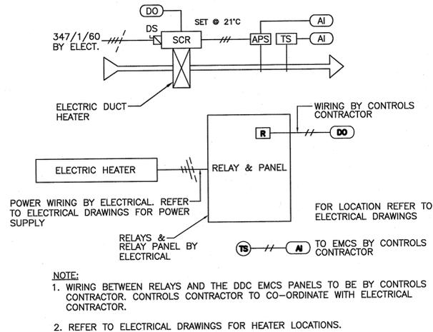
TYPICAL EXTERIOR HEATING CONTROLS
