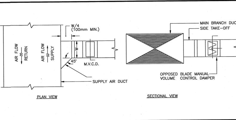
TYPICAL SIDE TAKE-OFF FOR RECTANGULAR BRANCH DUCTWORK
