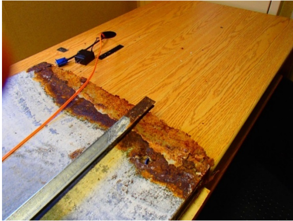
Figure 1 : Bas de panneau Joiner corrodé
