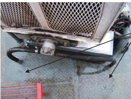
Orifices ou perforations sur le pont destinés à des boyaux.
