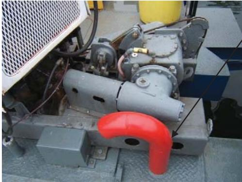
Orifice sur le pont du chaland destiné à un conduit d'aération.
