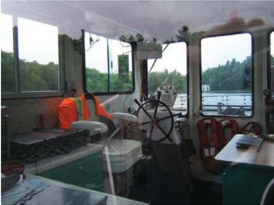
Les socles sur lesquels sont montés les pupitres de commande doivent être remplacés par des socles neufs adaptés aux nouveaux pupitres. La hauteur des socles devra être approuvée par le représentant de Parcs Canada.
