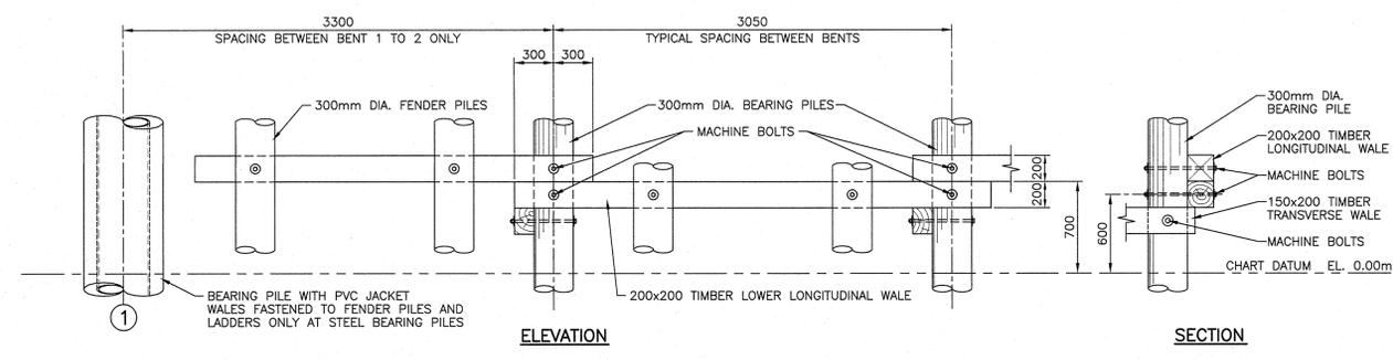
**LOWER LONGITUDINAL AND TRANSVERSE WALE FASTENING DETAIL**
