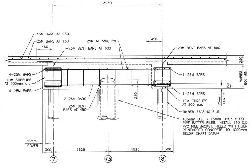
**BATTER PILE CLUSTER LONGITUDINAL SECTION** (G/6/6)
