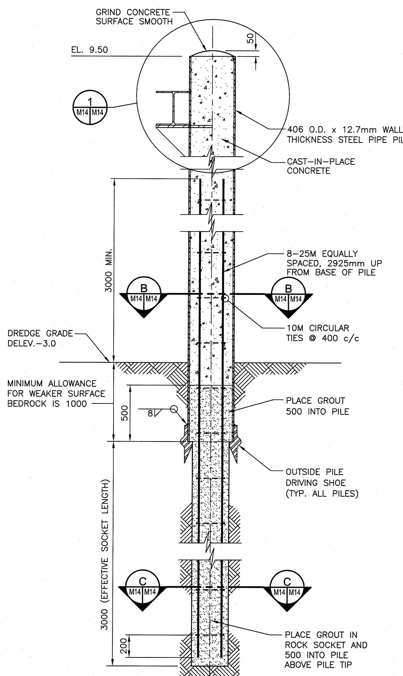
**TYPICAL ROCK SOCKET REINFORCING DETAIL**
