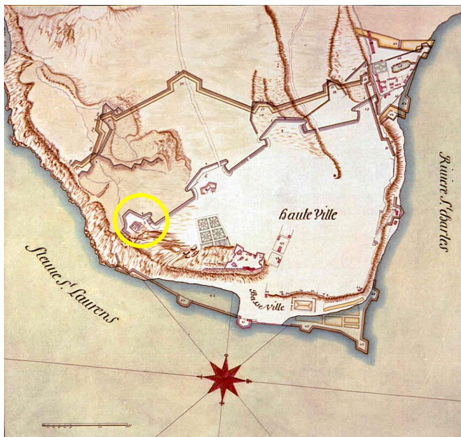
Figure 2 : plan de 1700 - Ligne de fortification de de Beaucours et ouvrages de défense construits plus à l'ouest par Levasseur de Neré. (1700-106-00-ic-6.jpg)
