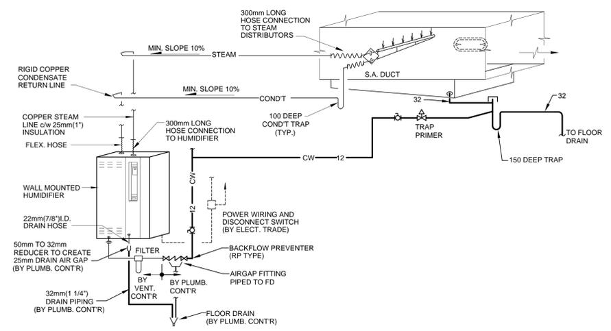
TYPICAL HUMIDIFIER PIPING SCHEMATIC
