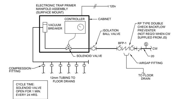
TYPICAL TRAP PRIMER STATION (TPS) PIPING DETAIL
