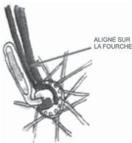
Figure 8 Position correcte du levier de démontage rapide
