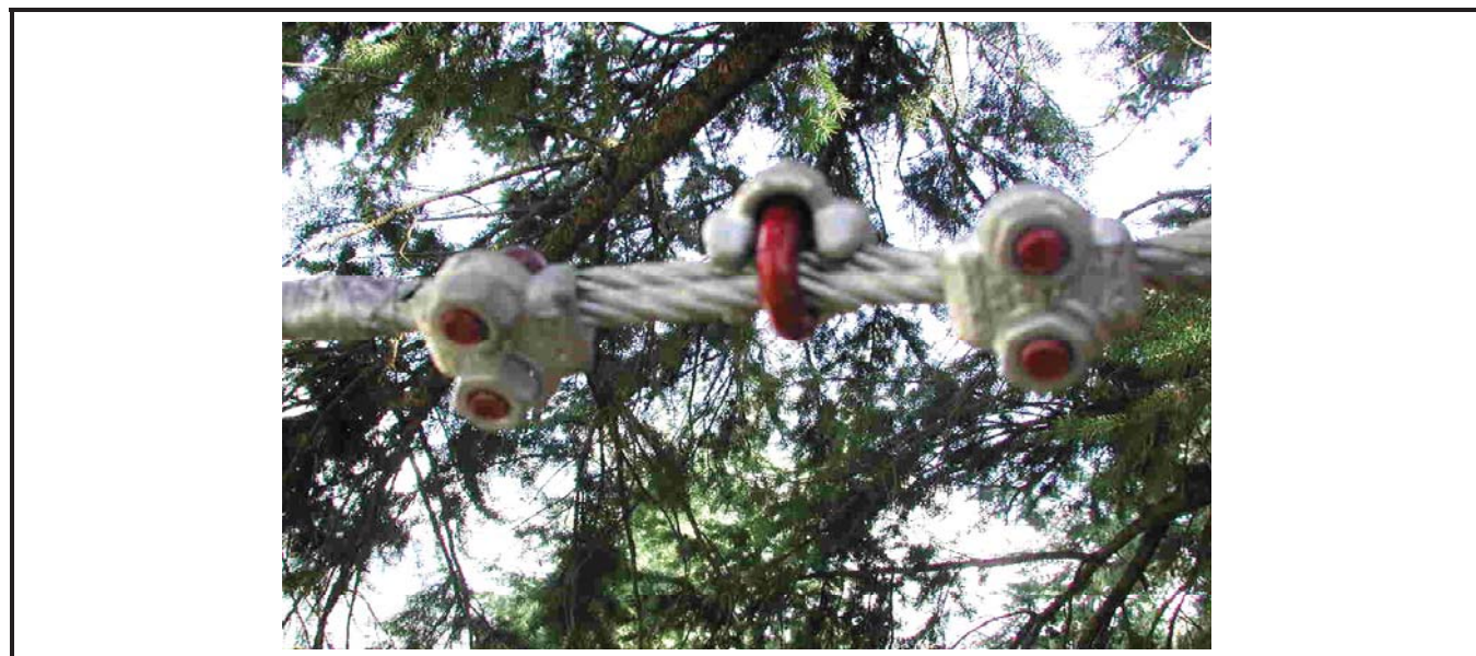
Figure 11A-3 Emplacement des ferrures d'assemblage sur les câbles de sécurité
