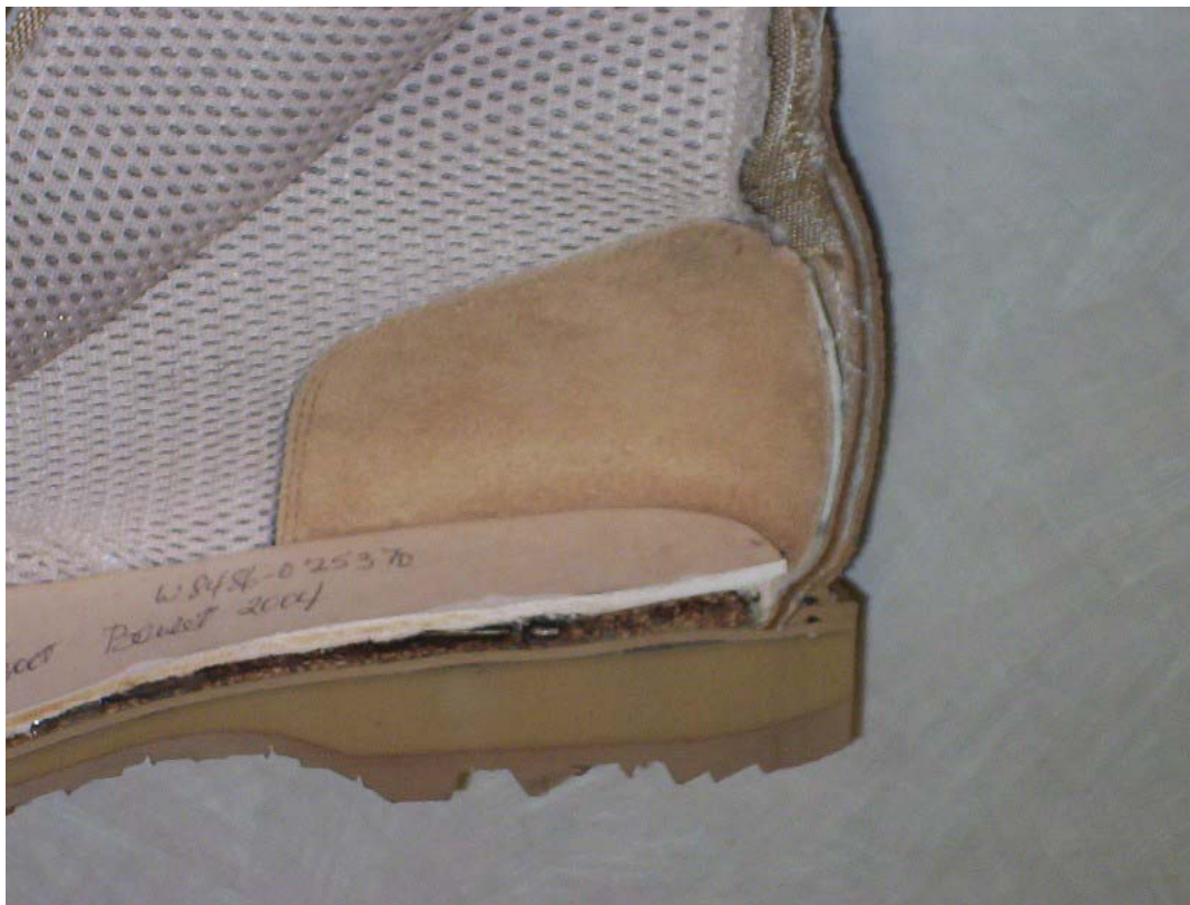
Figure 7 : Partie du talon et du contrefort illustrant l'assemblage du sous-contrefort et de la doublure
