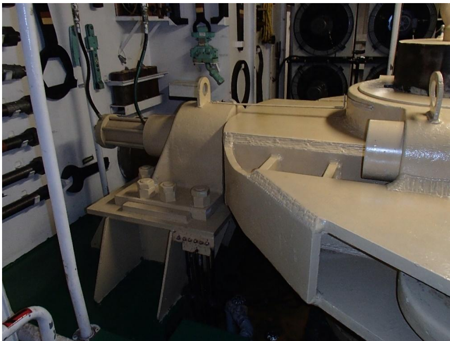
Photo no. 9 : Des Groseilliers Lock Pin – Cheville de bloquage
