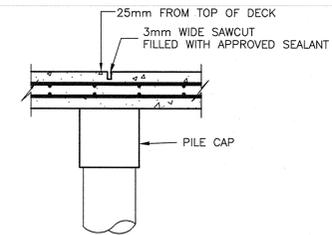
**TYPICAL CONTROL JOINT DETAIL**
