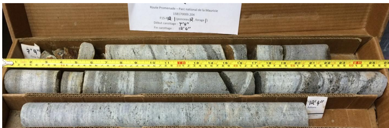
Photo n° 12 : Carottes de roc - forage F15-P12-1 – Ponceau RP-62240
