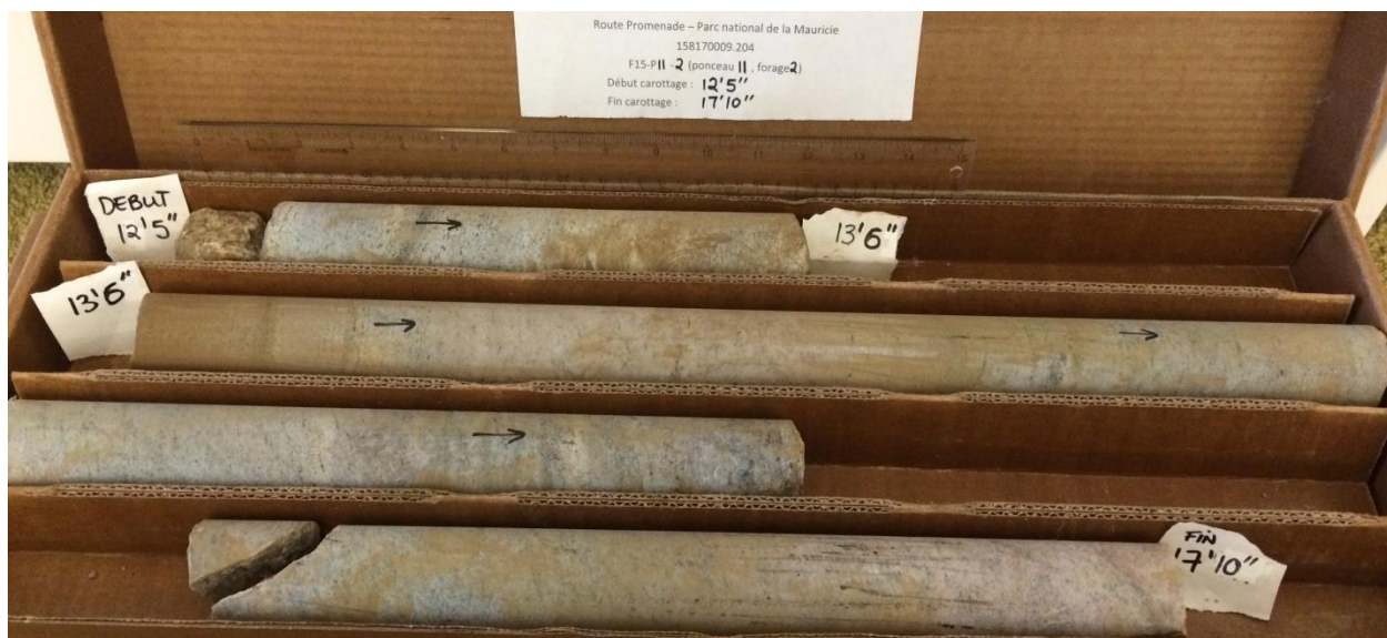
Photo n° 11 : Carottes de roc - forage F15-P11-2 – Ponceau RP-62064
