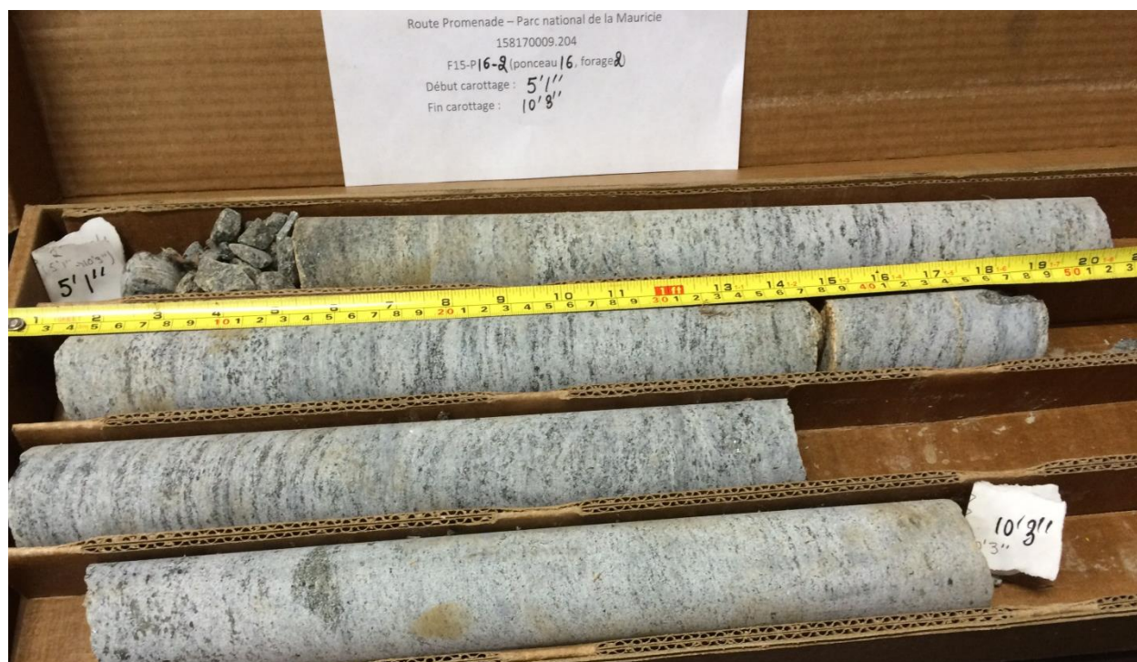
Photo n° 5 : Carottes de roc - forage F15-P16-2 – Ponceau RP-47306
