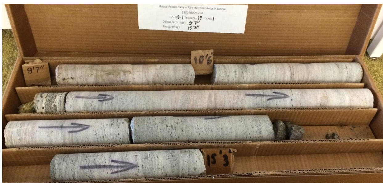
Photo n° 14 : Carottes de roc - forage F15-P19-1 – Ponceau RP-62600
