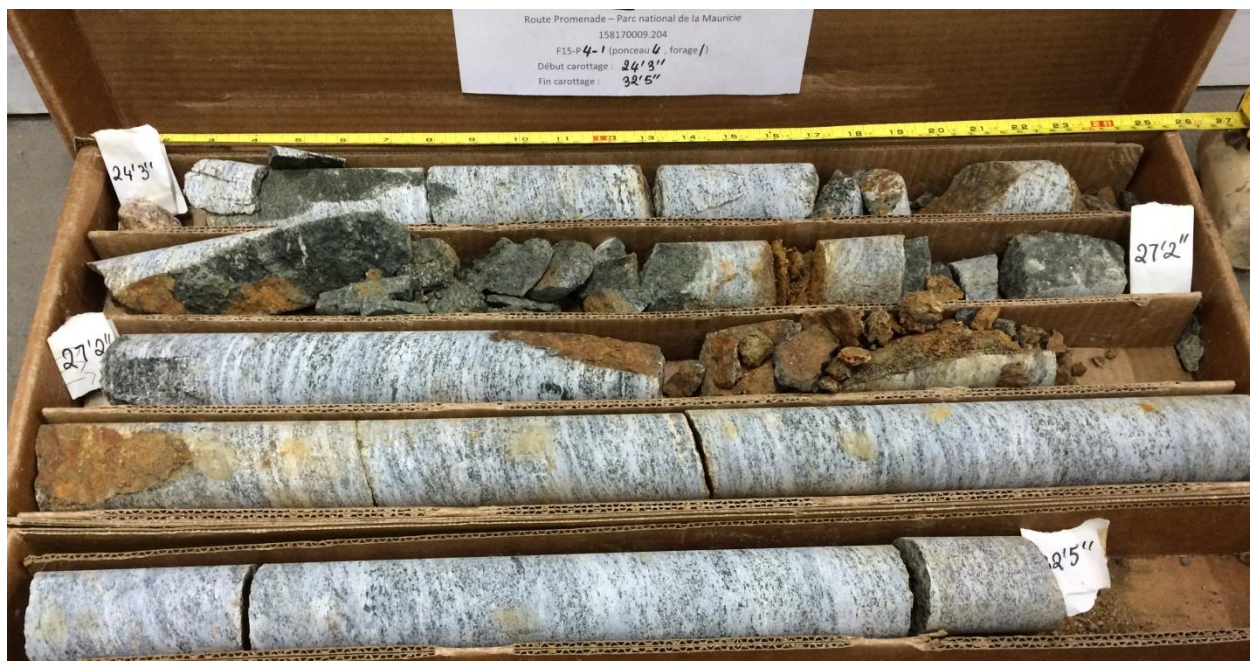
Photo n° 7 : Carottes de roc - forage F15-P4-1 – Ponceau RP-48517
