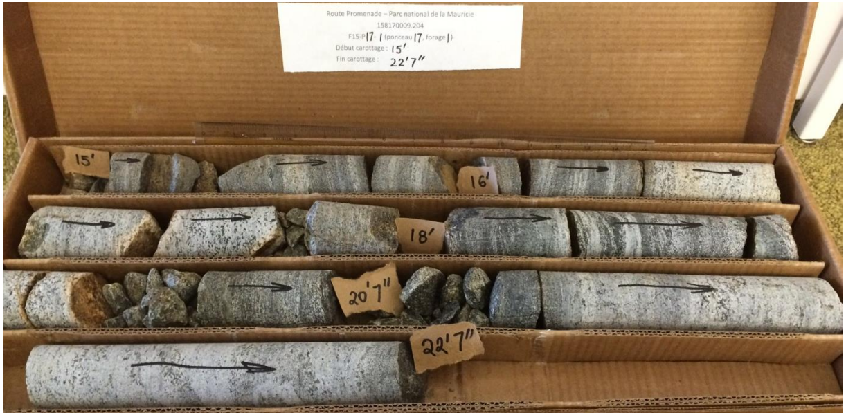
Photo n° 1 : Carottes de roc - forage F15-P17-1 – Ponceau RP-41800
