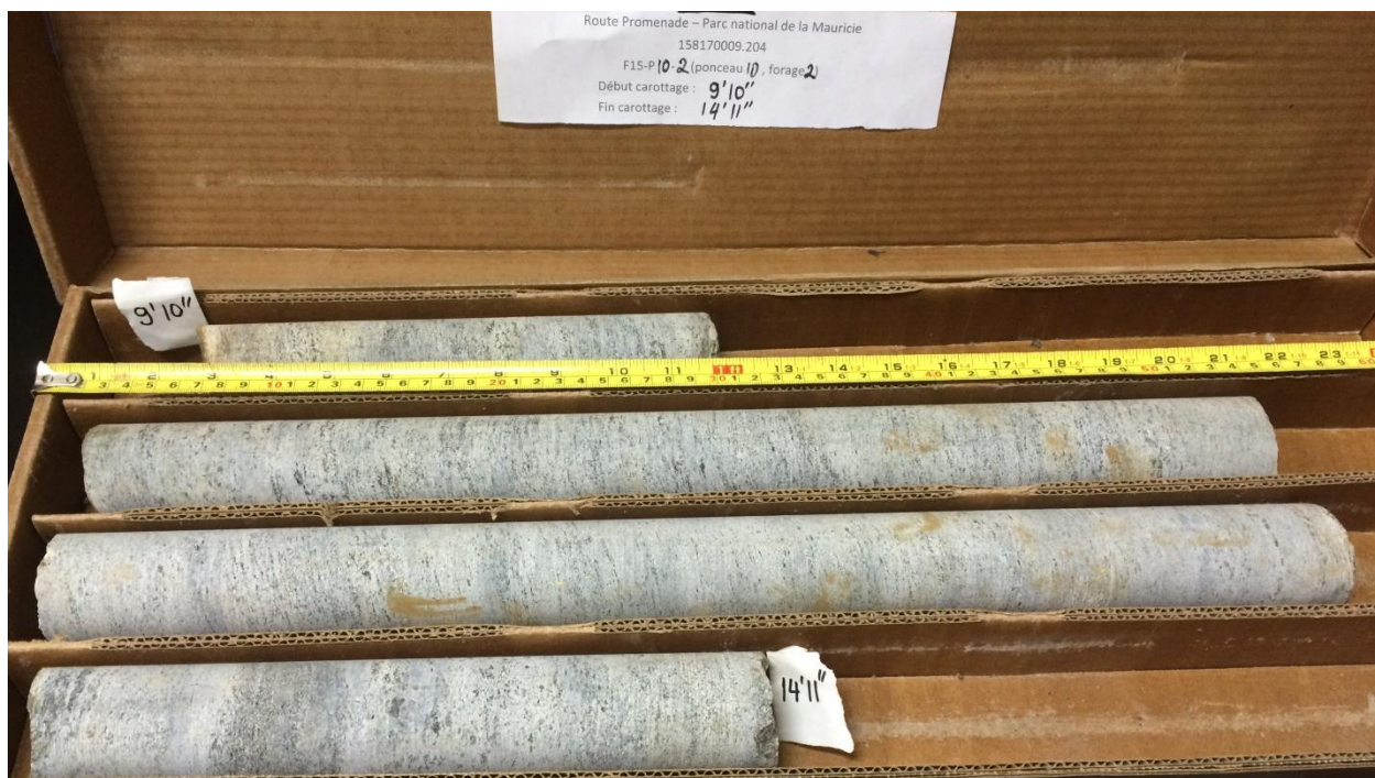
Photo n° 10 : Carottes de roc - forage F15-P10-2 – Ponceau RP-61345
