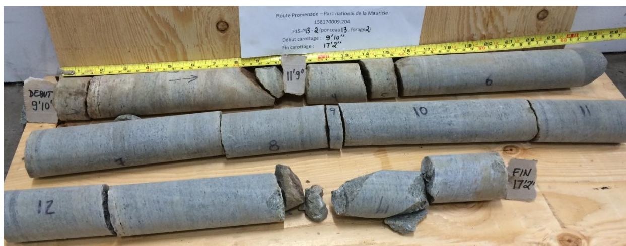
Photo n° 13 : Carottes de roc - forage F15-P13-2 – Ponceau RP-62550
