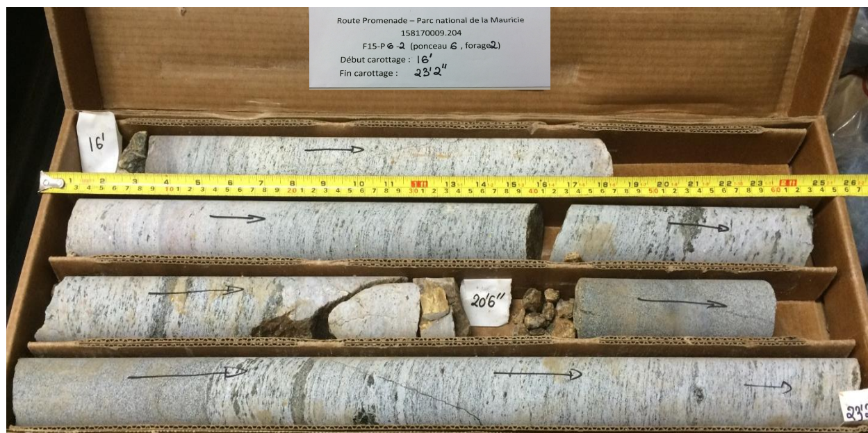
Photo n° 9 : Carottes de roc - forage F15-P6-2 – Ponceau RP-56545
