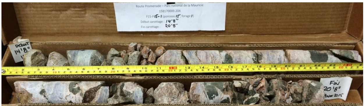
Photo n° 3 : Carottes de roc - forage F15-P15-1 – Ponceau RP-42266
