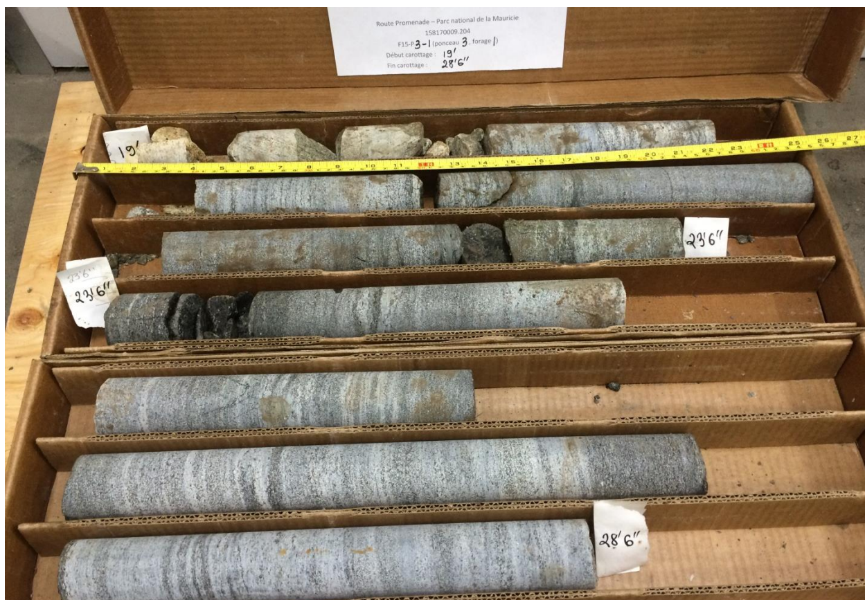
Photo n° 4 : Carottes de roc - forage F15-P3-1 – Ponceau RP-42450
