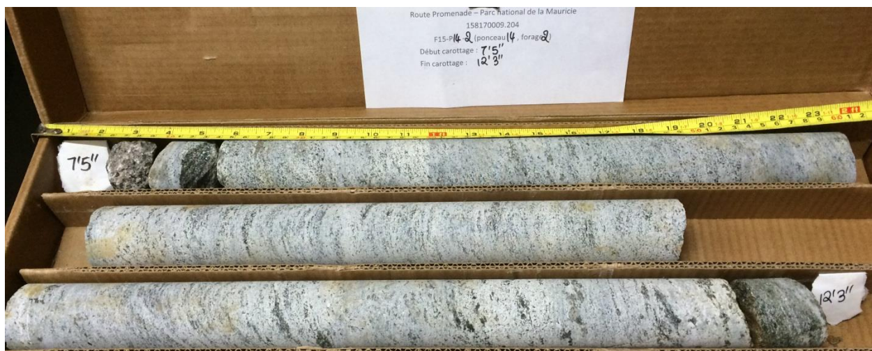
Photo n° 6 : Carottes de roc - forage F15-P14-2 – Ponceau RP-47510
