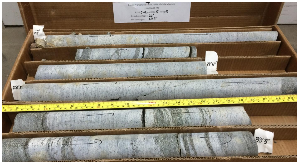
Photo n° 8 : Carottes de roc - forage F15-P5-2 – Ponceau RP-49970
