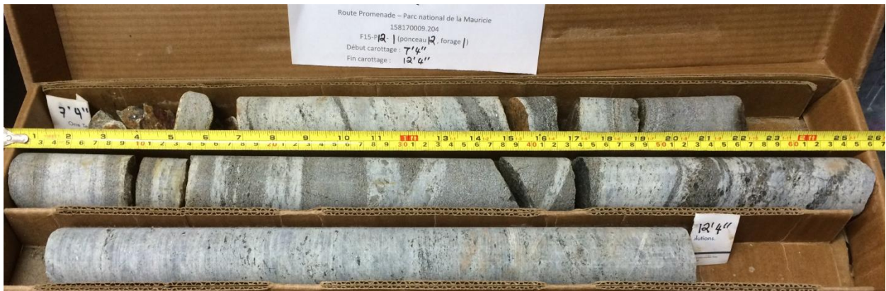
Photo n° 2 : Carottes de roc - forage F15-P2-1 – Ponceau RP-41900
