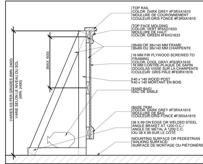
**HOARDING TYPE B / CLÔTURE TYPE B** SCALE 1:10 / ÉCHELLE 1:10
