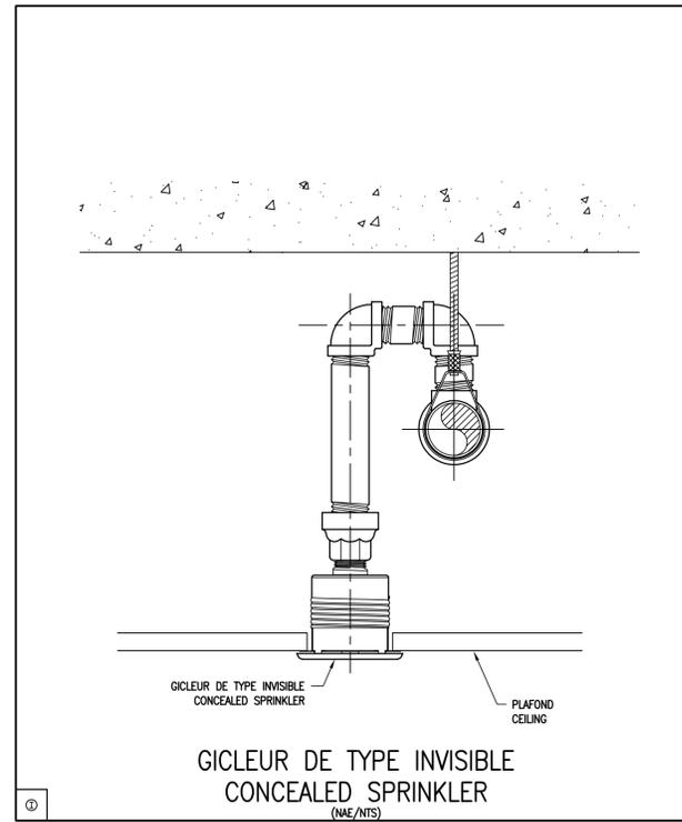
GICLÉUR DE TYPE INVISIBLE CONCEALED SPRINKLER (N/E/NTS)
