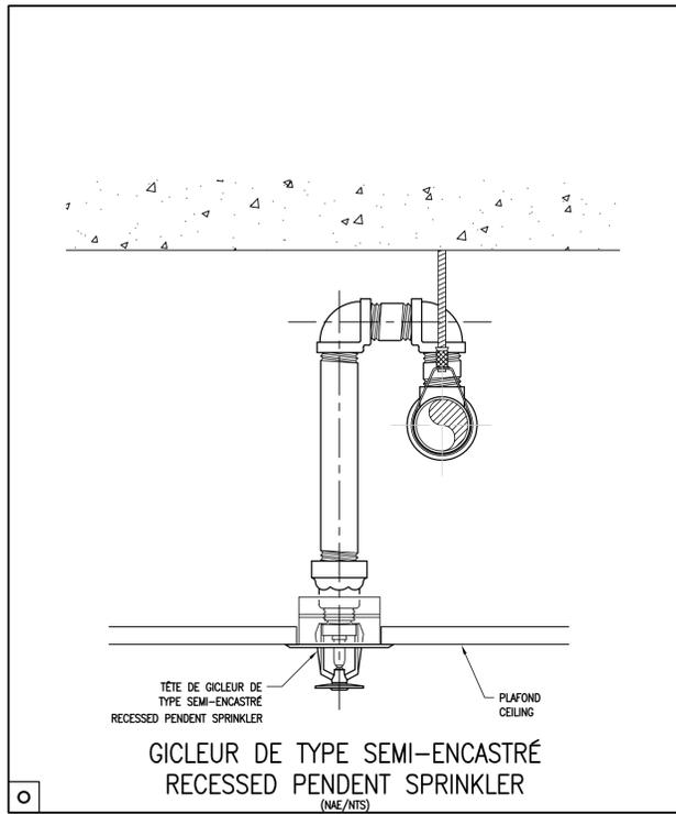
GICLÉUR DE TYPE SEMI-ENCASTRÉ RECESSED PENDENT SPRINKLER (N/E/NTS)
