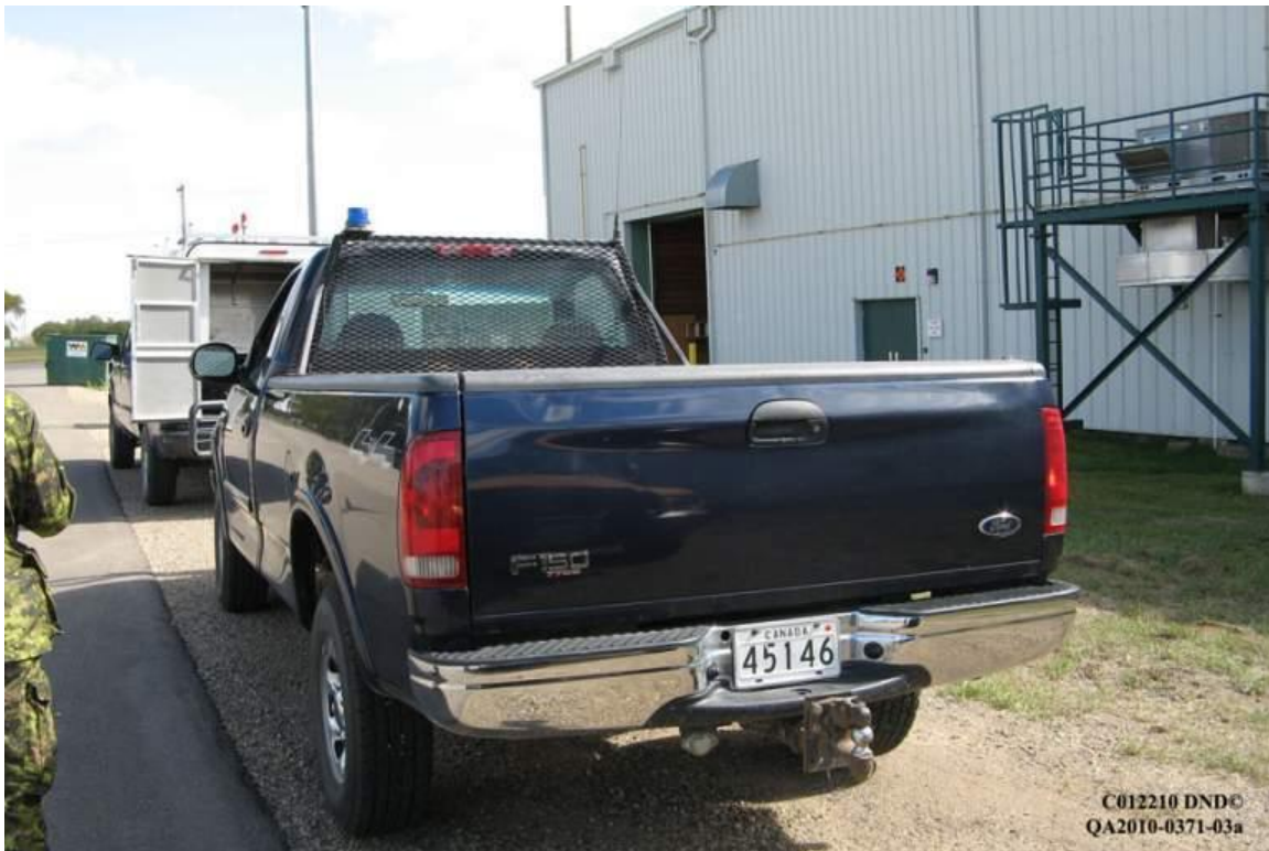
Figure 14 : Exemple d'une antenne incorrectement installée sur une grille métallique d'un véhicule du MDN et des FC. La grille métallique réfléchit l'énergie électromagnétique des RF [C012210].
