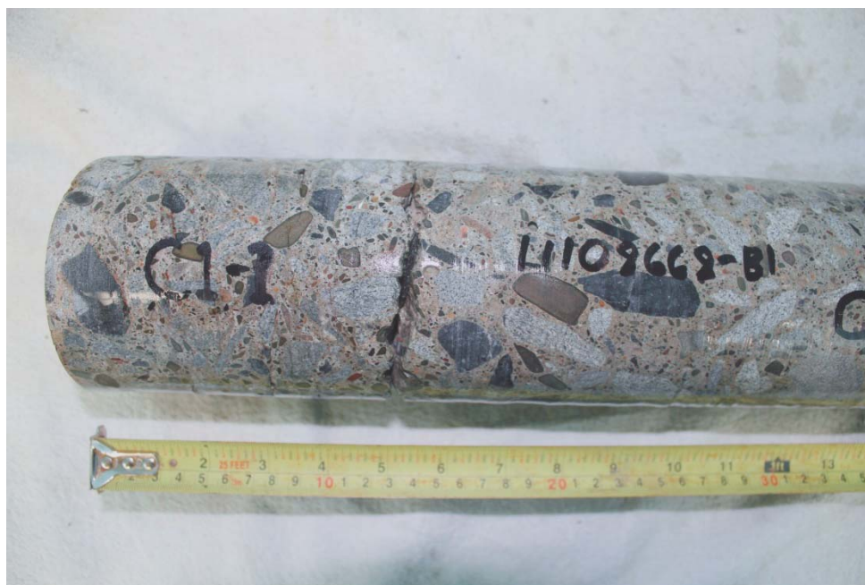
Photo 3 – Carotte C1 (profondeur 0-300 mm).
