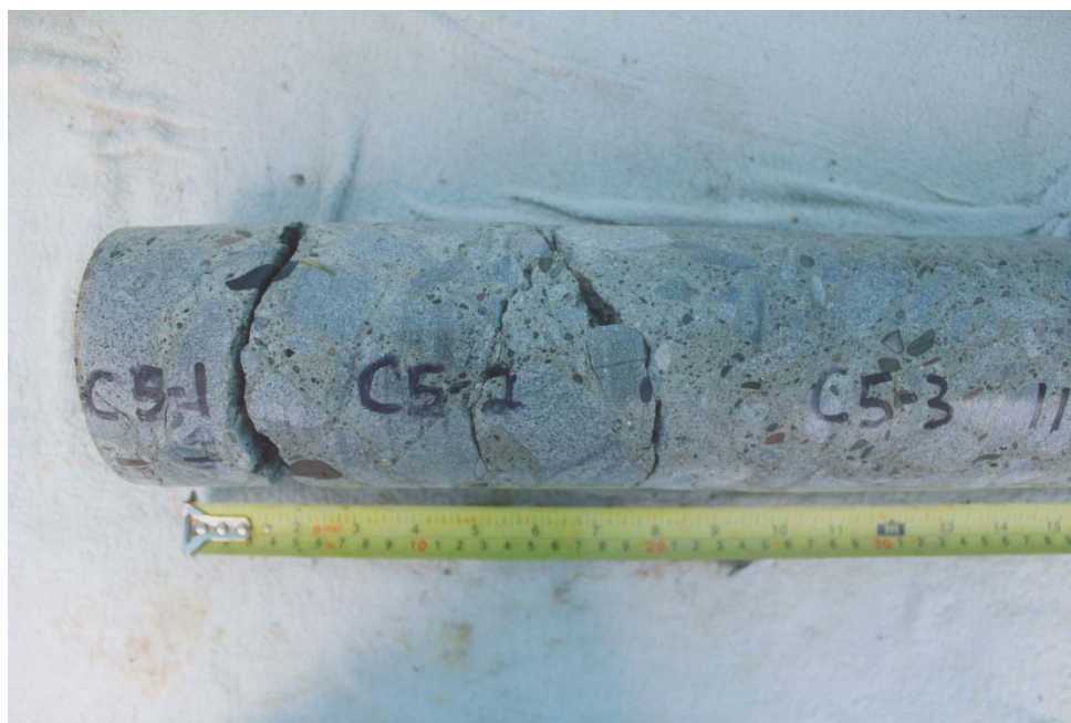
Photo 11 – Carotte C5 (profondeur 0-300 mm).
