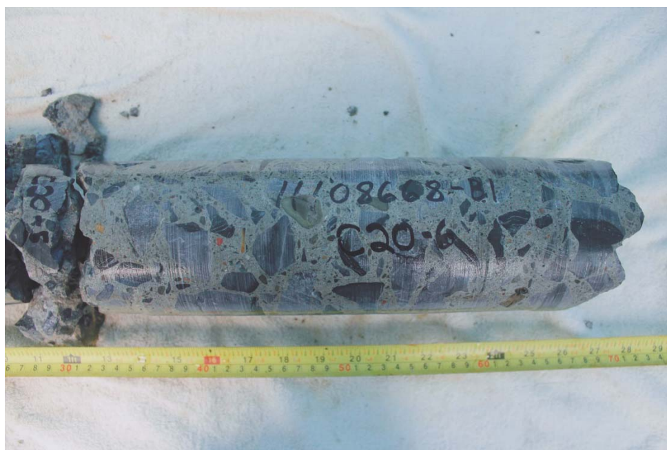
Photo 42 – Carotte C20 (profondeur 300-650 mm).
