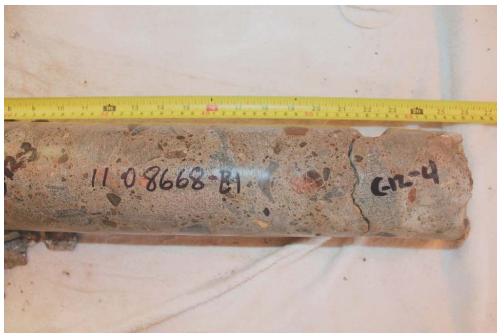
Photo 26 – Carotte C12 (profondeur 300-640 mm).
