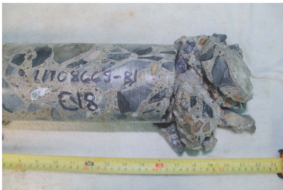
Photo 38 – Carotte C18 (profondeur 300-500 mm).
