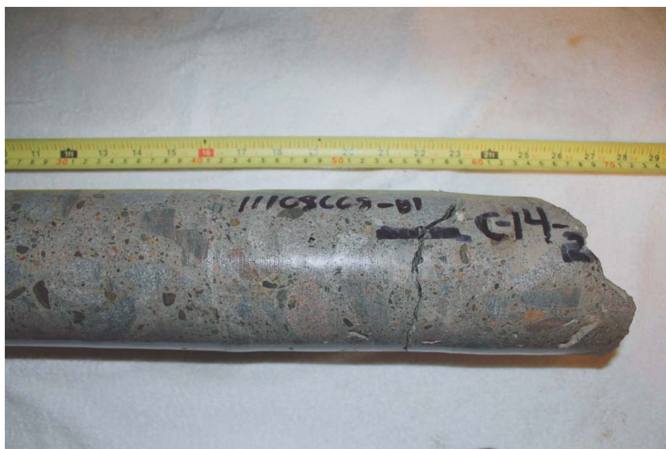
Photo 30 – Carotte C14 (profondeur 300-650 mm).
