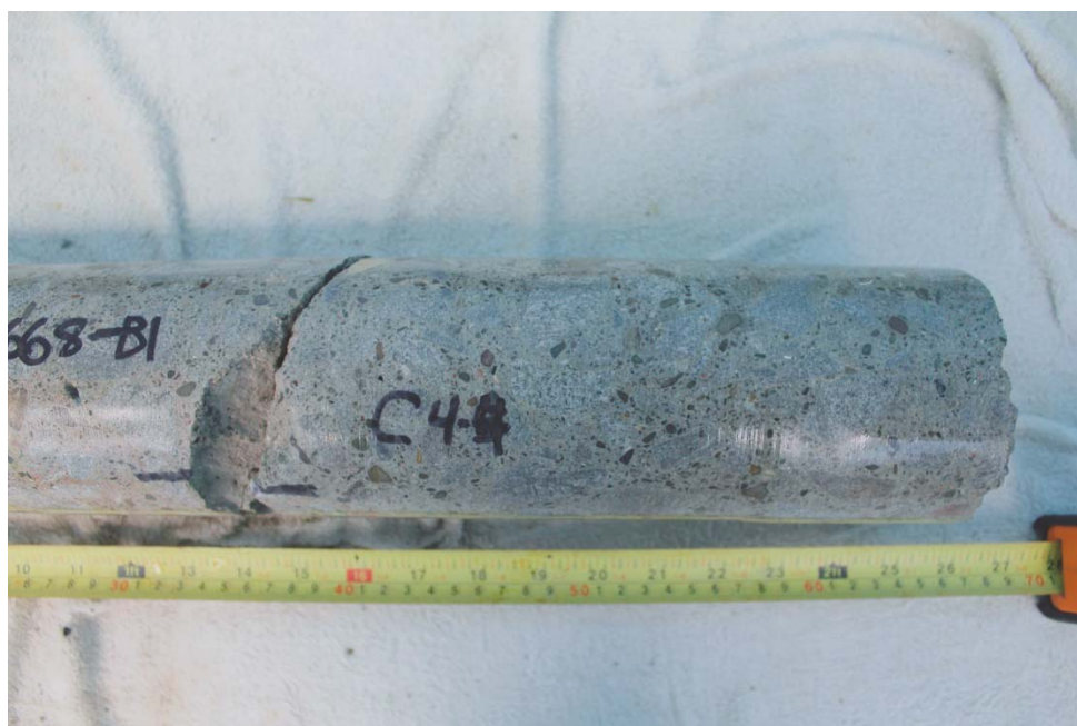
Photo 10 – Carotte C4 (profondeur 300-650 mm).
