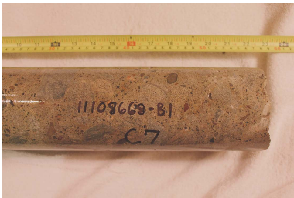
Photo 16 – Carotte C7 (profondeur 300-570 mm).
