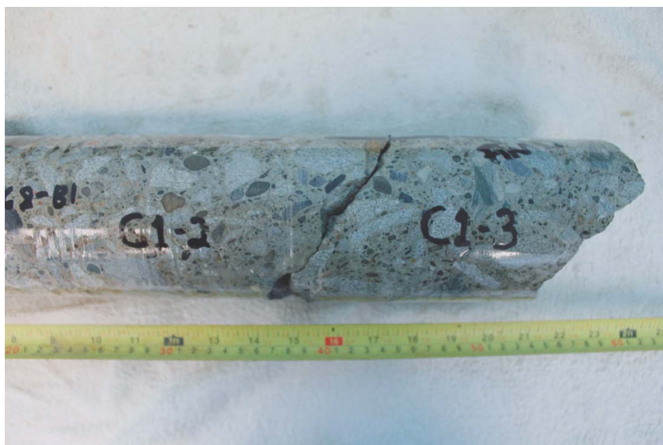
Photo 4 – Carotte C1 (profondeur 300-560 mm).
