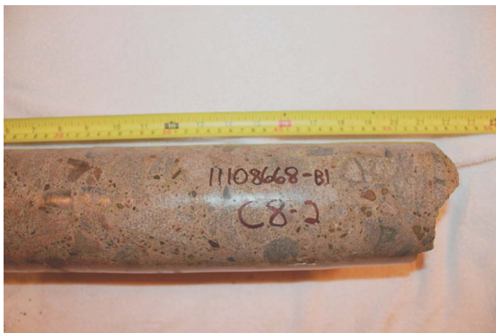
Photo 18 – Carotte C8 (profondeur 300-520 mm).
