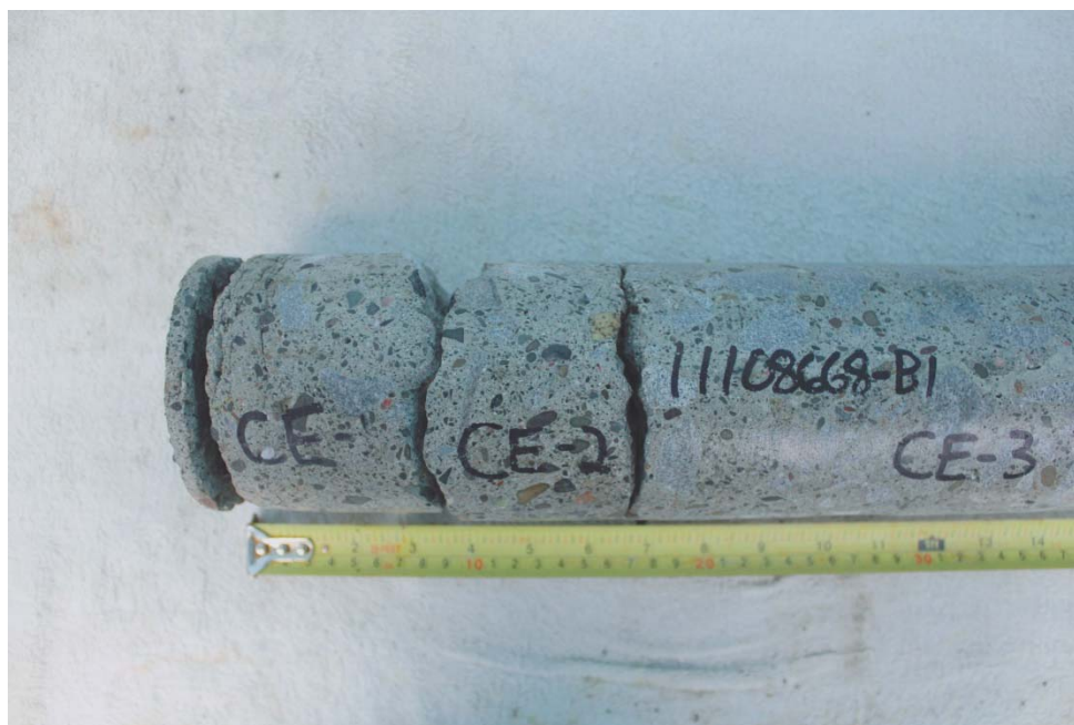
Photo 1 – Carotte CE (profondeur 0-300 mm).
