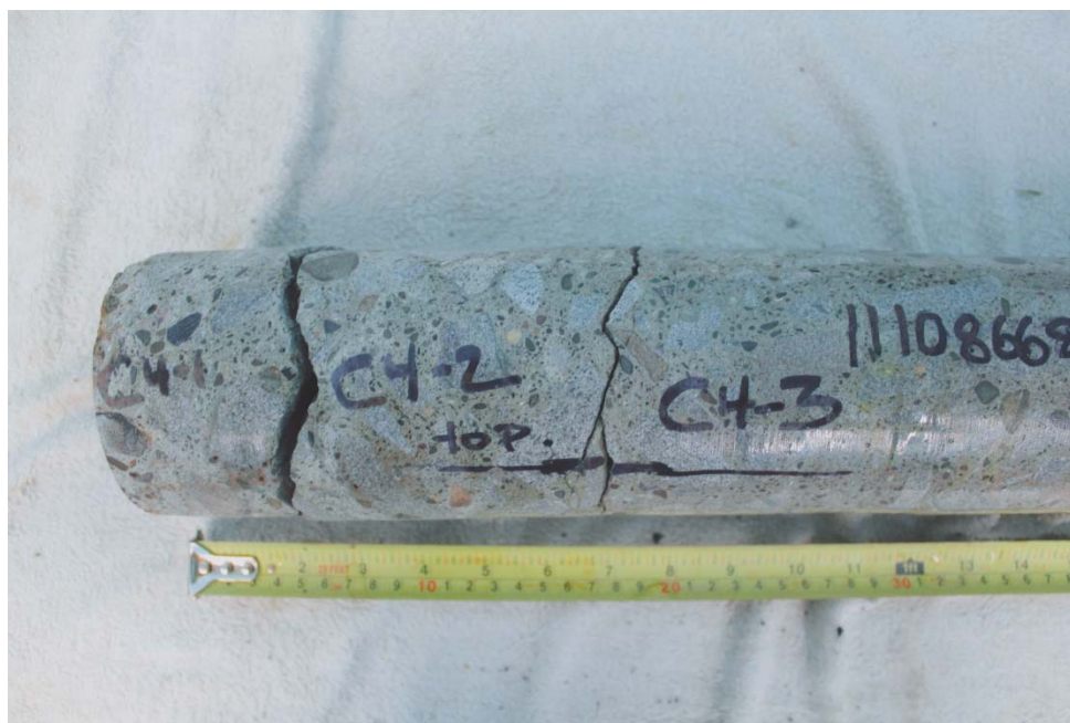
Photo 9 – Carotte C4 (profondeur 0-300 mm).
