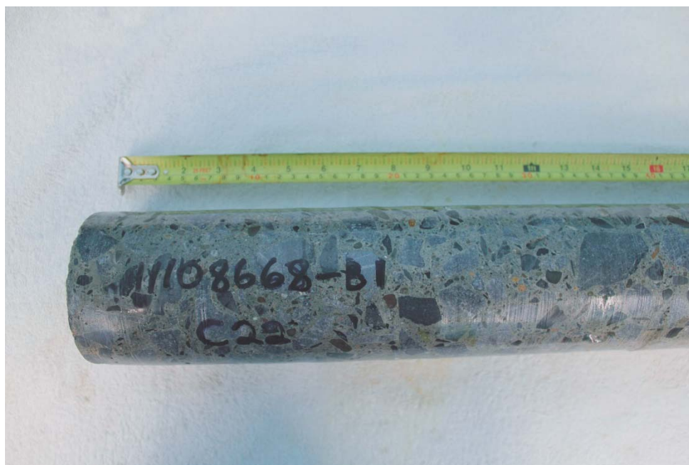
Photo 45 – Carotte C22 (profondeur 0-300 mm).
