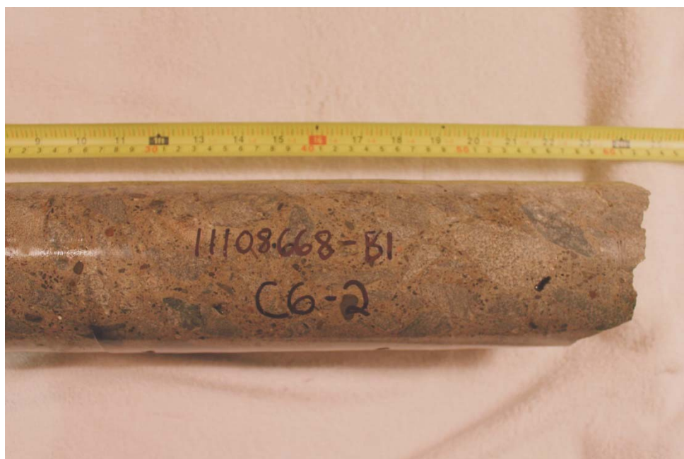
Photo 14 – Carotte C6 (profondeur 300-600 mm).
