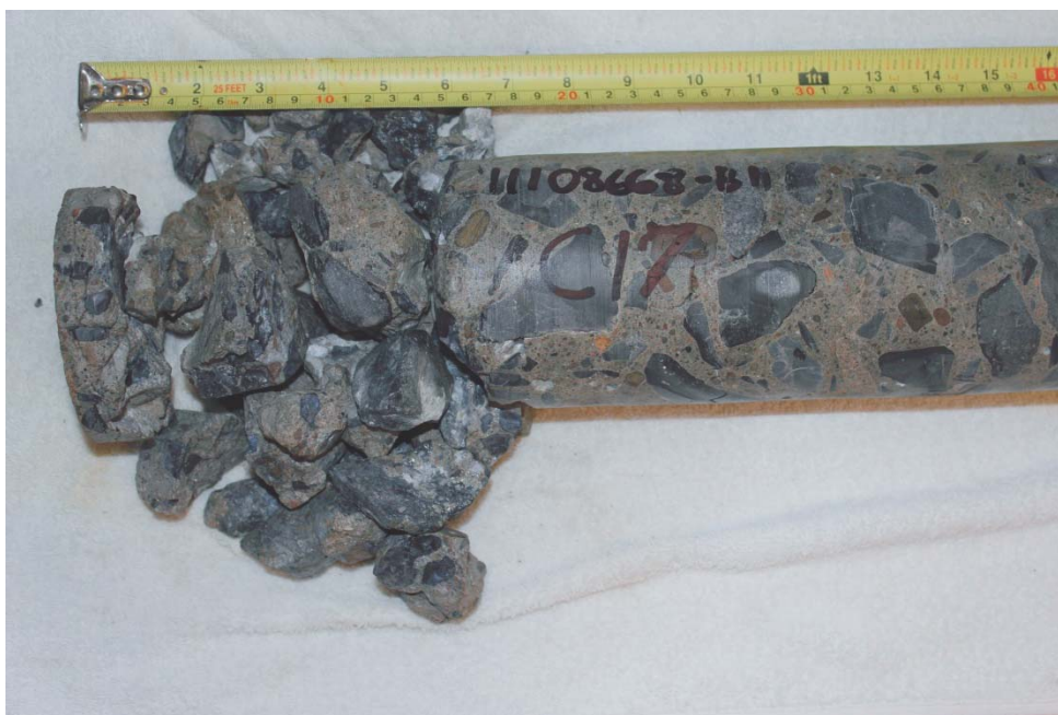
Photo 35 – Carotte C17 (profondeur 0-300 mm).
