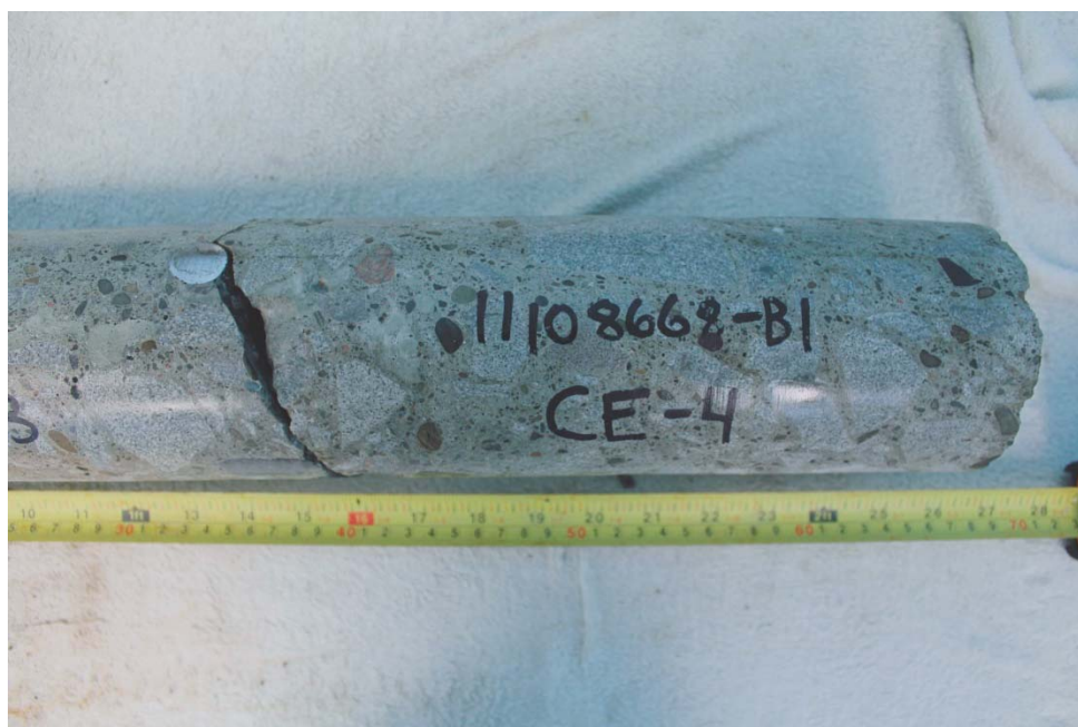
Photo 2 – Carotte CE (profondeur 300-650 mm).
