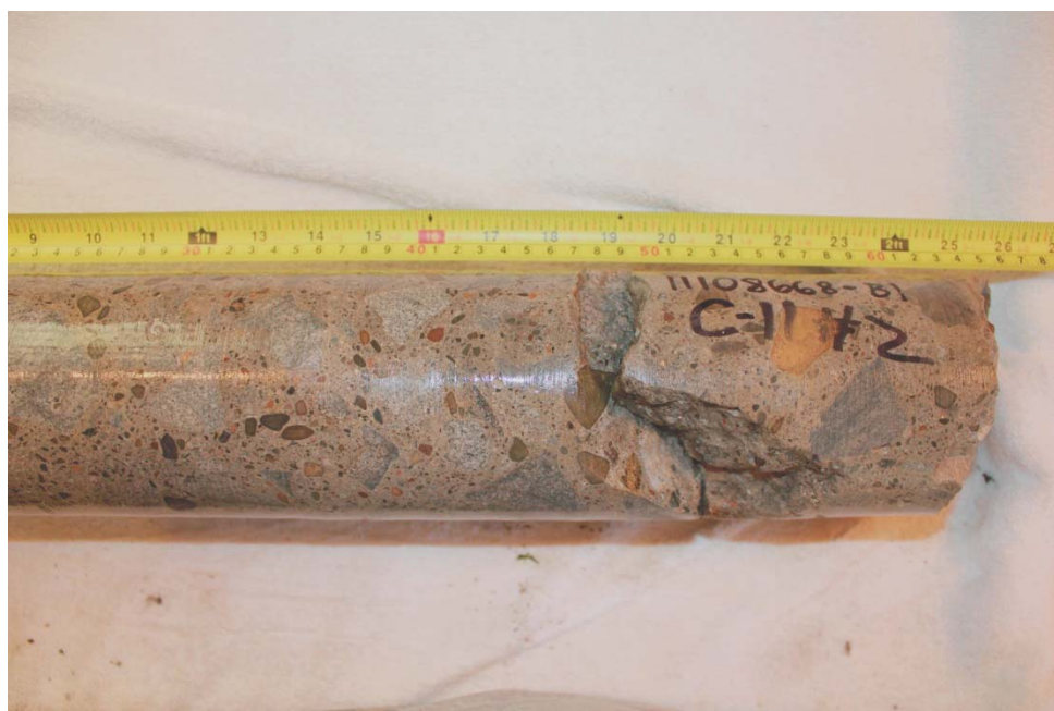
Photo 24 – Carotte C11 (profondeur 300-650 mm).
