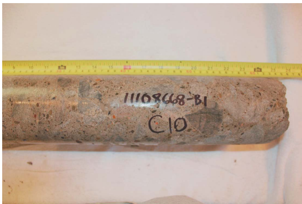
Photo 22 – Carotte C10 (profondeur 300-620 mm).
