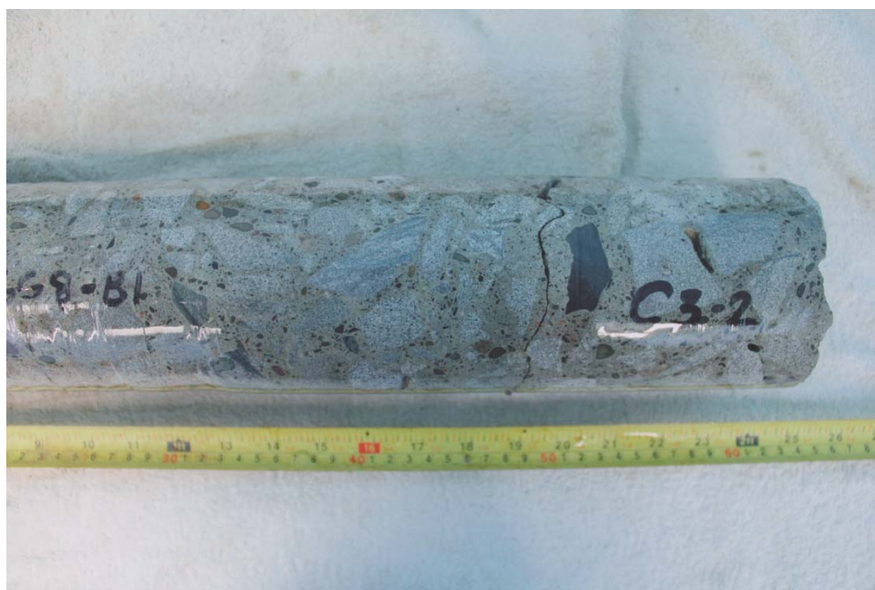
Photo 8 – Carotte C3 (profondeur 300-620 mm).
