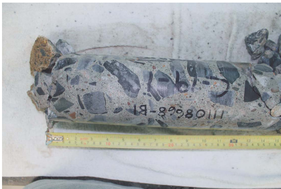
Photo 39 – Carotte C19 (profondeur 0-300 mm).
