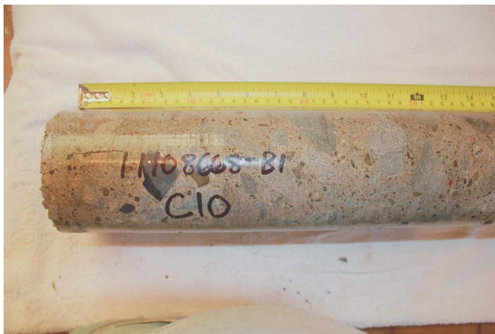
Photo 21 – Carotte C10 (profondeur 0-300 mm).
