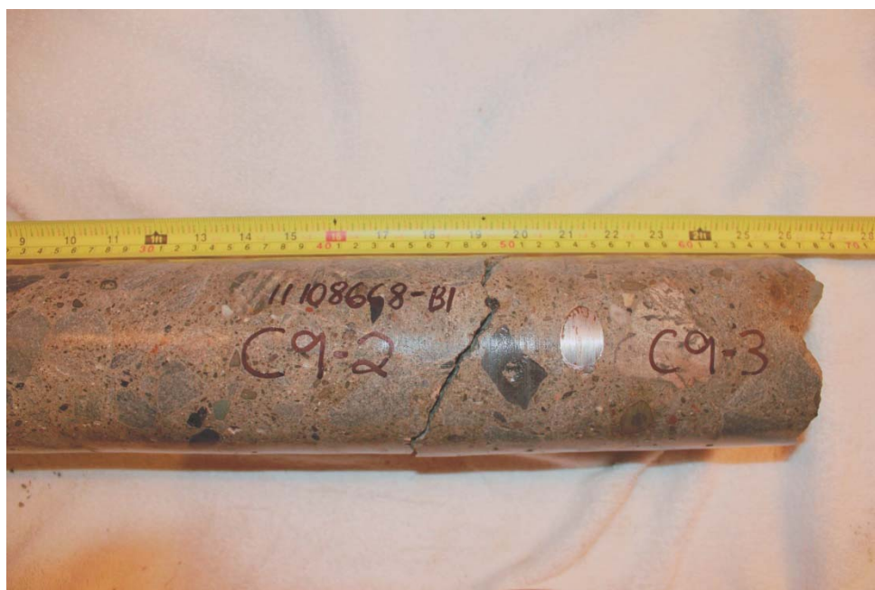
Photo 20 – Carotte C9 (profondeur 300-640 mm).
