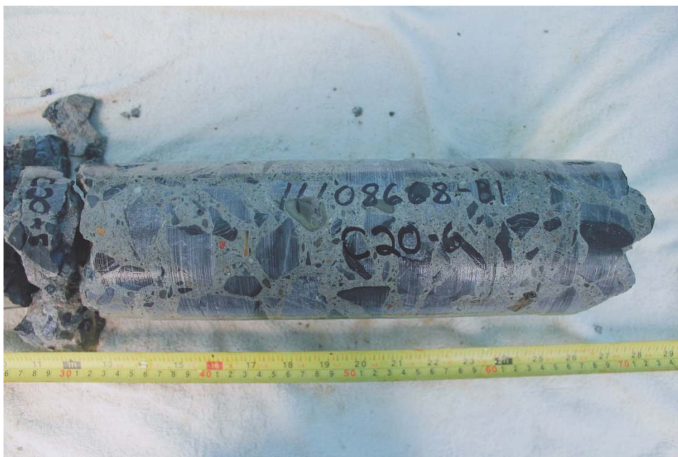
Photo 42 – Carotte C20 (profondeur 300-650 mm).
