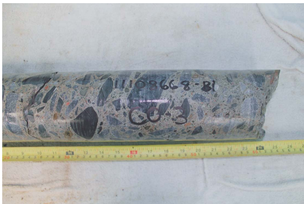
Photo 48 – Carotte CO (profondeur 300-610 mm).
