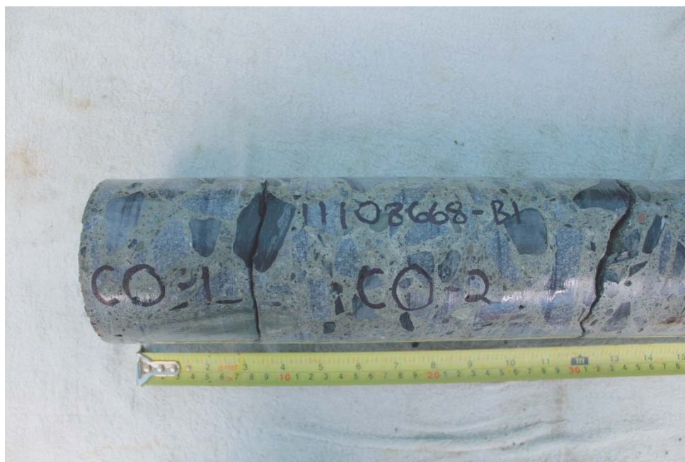
Photo 47 – Carotte CO (profondeur 0-300 mm).
