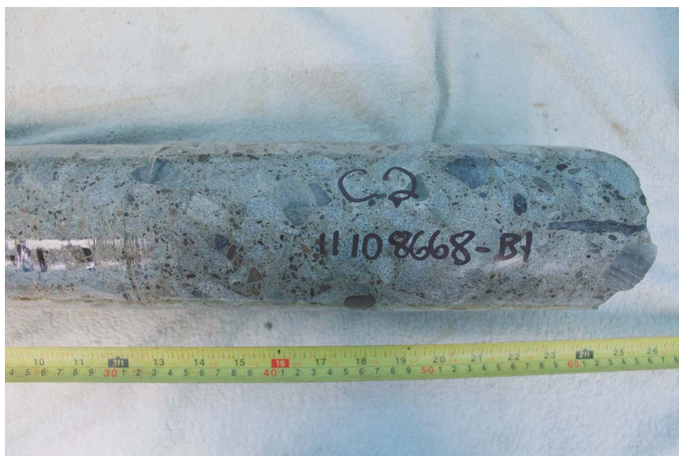
Photo 6 – Carotte C2 (profondeur 300-610 mm).
