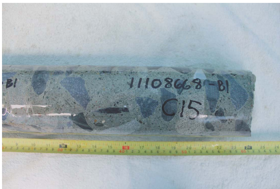
Photo 32 – Carotte C15 (profondeur 300-600 mm).
