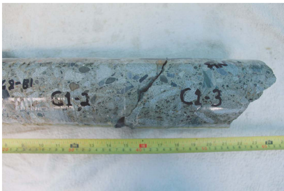
Photo 4 – Carotte C1 (profondeur 300-560 mm).
