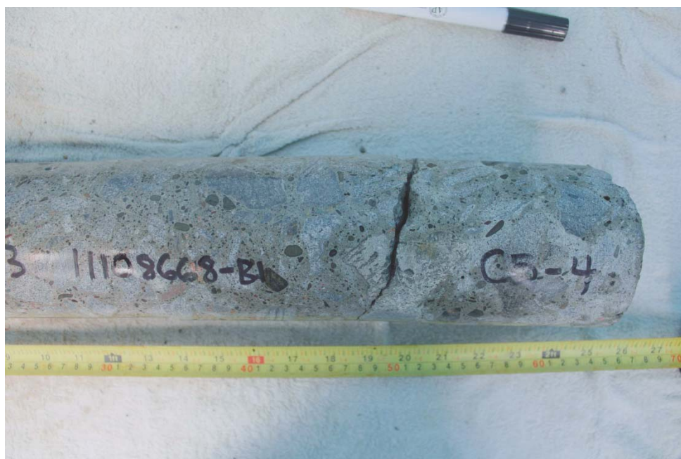
Photo 12 – Carotte C5 (profondeur 300-650 mm).
