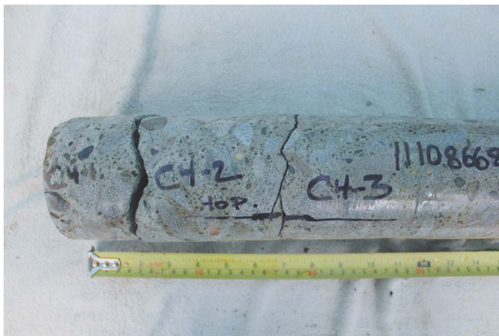
Photo 9 – Carotte C4 (profondeur 0-300 mm).
