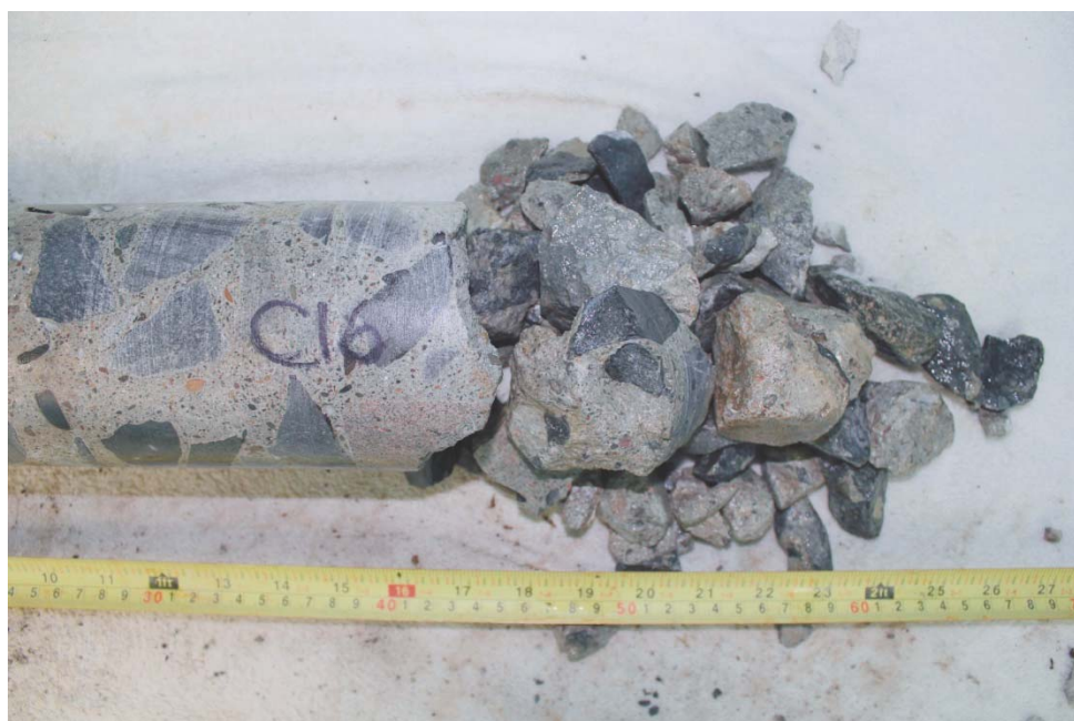
Photo 34 – Carotte C16 (profondeur 300-550 mm).
