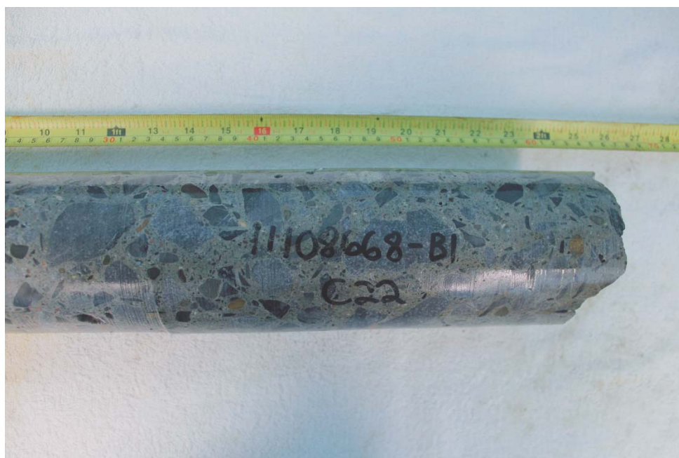
Photo 46 – Carotte C22 (profondeur 300-610 mm).
