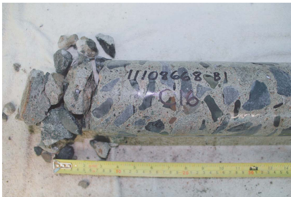
Photo 33 – Carotte C16 (profondeur 0-300 mm).
