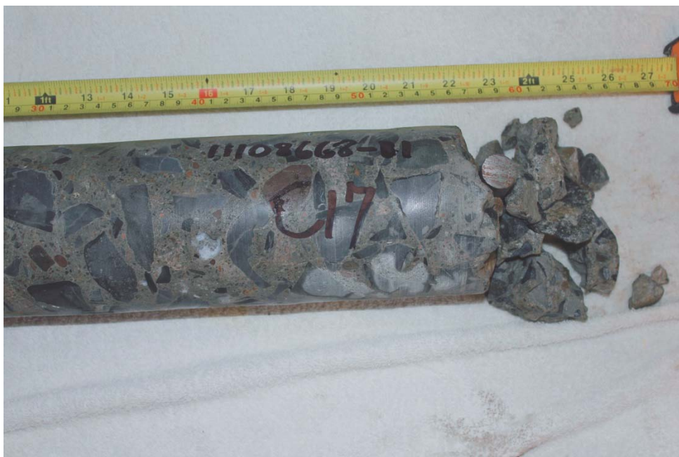
Photo 36 – Carotte C17 (profondeur 300-610 mm).
