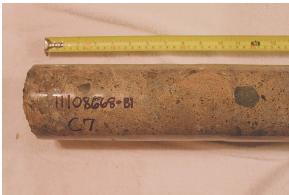
Photo 15 – Carotte C7 (profondeur 0-300 mm).
