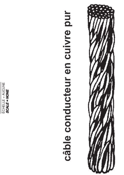
DETAIL #7 ÉCHELLE - AUCUNE SCALE - NONE
