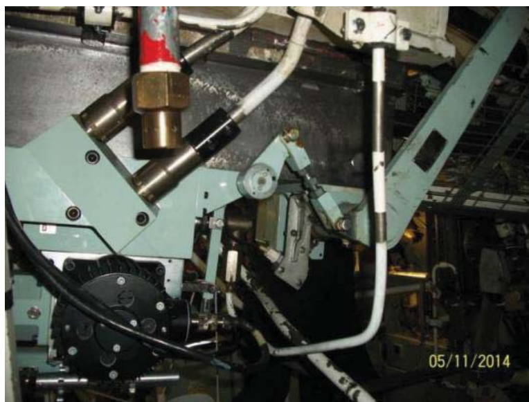
Figure 21: Connexions hydrauliques de la partie arrière de l'USV de la barre de plongée arrière
