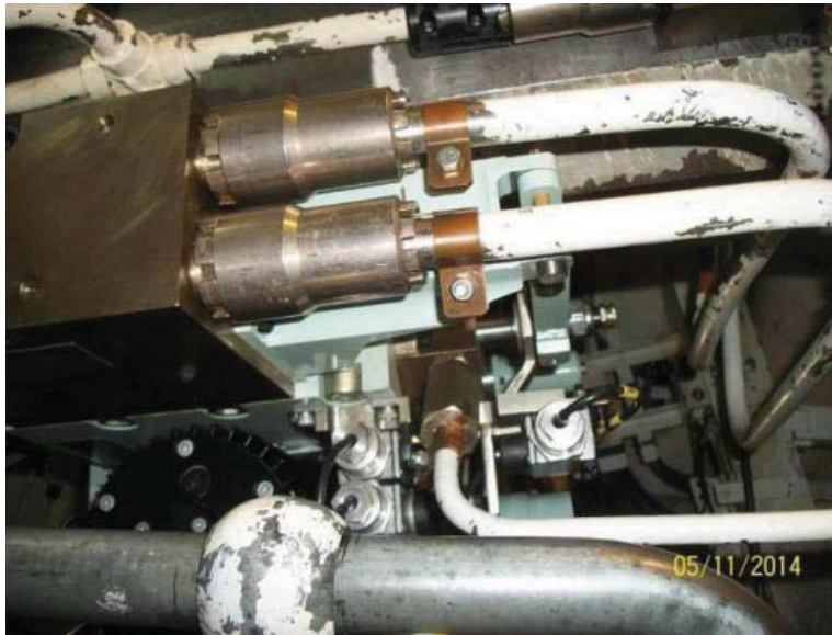
Figure 22: Connexions hydrauliques de la partie avant de l'USV de la barre de plongée arrière
