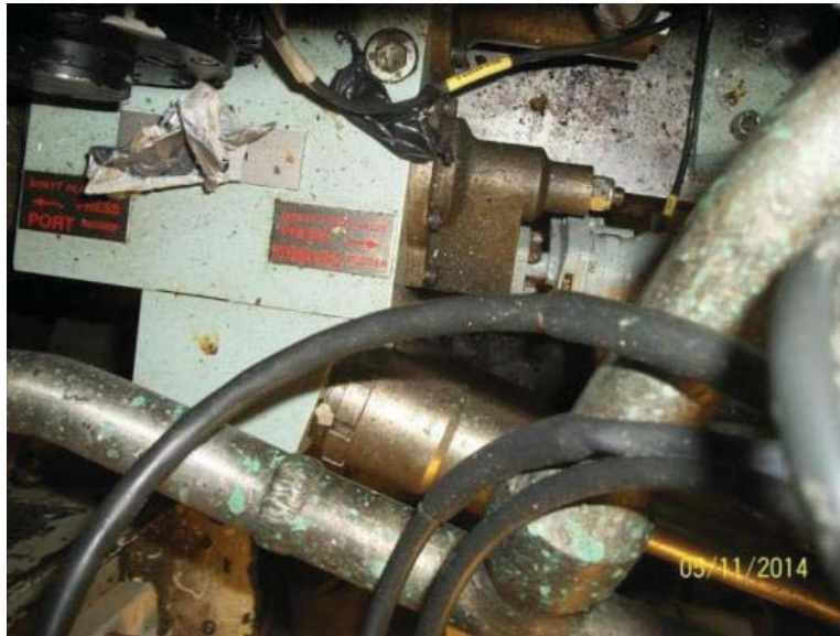
Figure 24 : Connexions hydrauliques de l'USV du gouvernail – Vue de dessus
