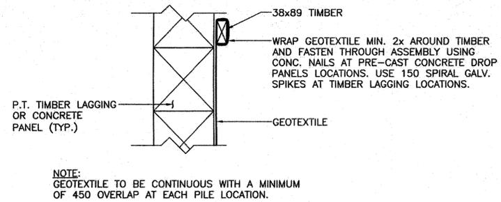
DETAIL - GEOTEXTILE FASTENING
