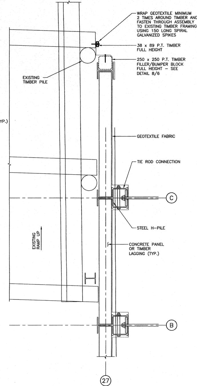
DETAIL - GEOTEXTILE CONNECTION AT GRIDLINE 27
