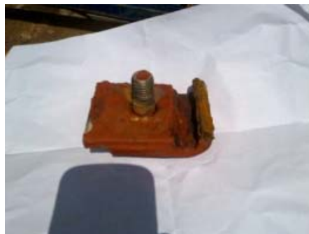
Exemple d'une patte de grille (brisée)
