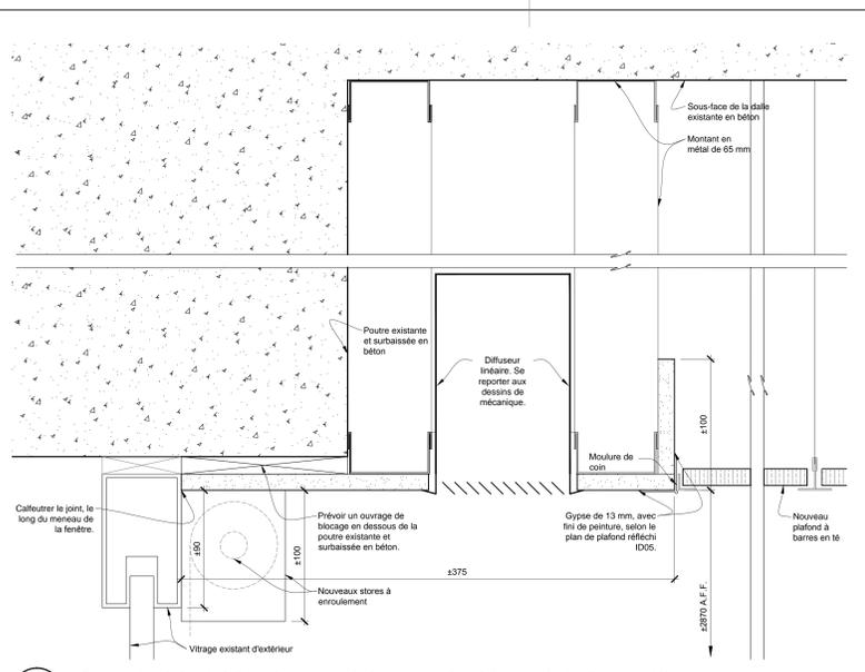
2 Coupe de plafond, à l'emplacement de la poutre d'extérieur surbaissée et en béton
