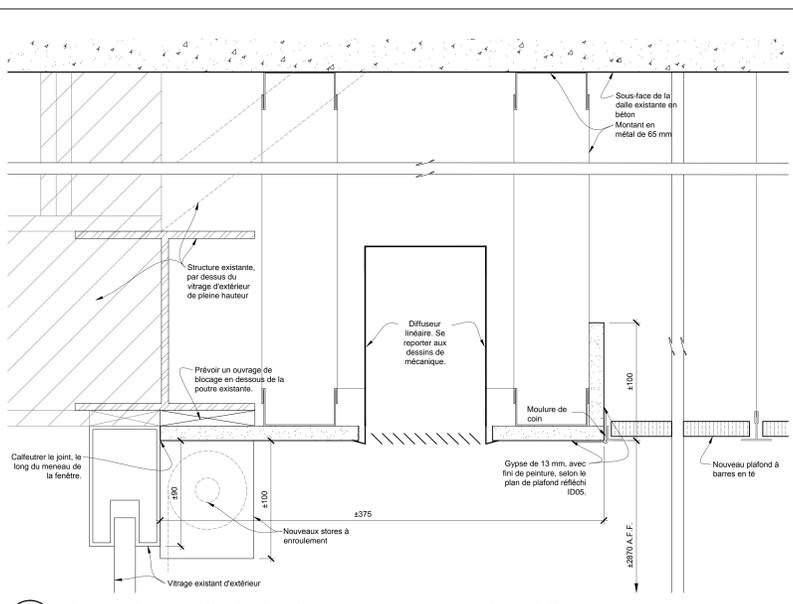
1 Coupe typique de plafond, à l'emplacement d'une cloison d'extérieur vitrifiée
