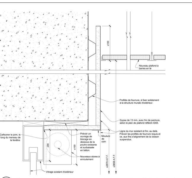
3 Coupe de plafond - Poutre d'extérieur surbaissée et en béton - Plafond surélevé
