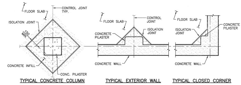
**DETAIL - TYPICAL PILASTER ISOLATION JOINTS**
