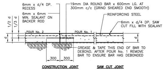
**DETAIL - TYPICAL CONTROL JOINT (C.J.) (SEE PLAN)**
