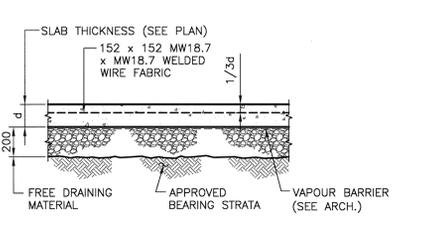
**DETAIL - TYPICAL SLAB ON GRADE**
