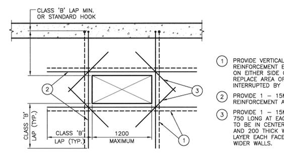
**DETAIL - TYPICAL REINFORCING AT RECTANGULAR OPENINGS**
