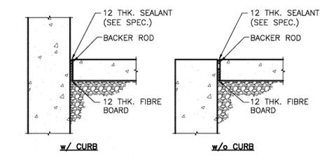
**DETAIL - TYPICAL ISOLATION JOINTS**
