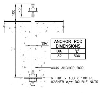
**DETAIL - TYPICAL ANCHOR RODS**
