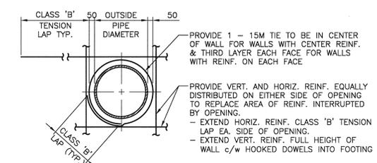
**DETAIL - TYPICAL REINFORCING AT ROUND OPENINGS**
