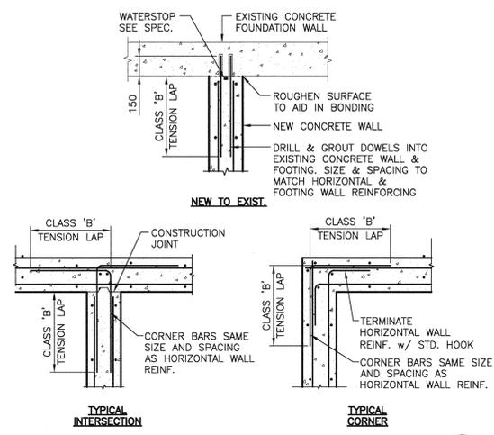
**DETAIL - TYPICAL FOUNDATION WALL PLANS**
