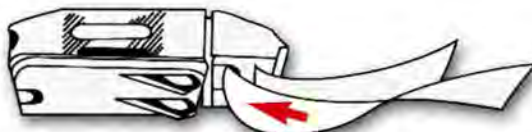
Figure 8-5 - Enfilage d'une boucle à déclenchement latéral
