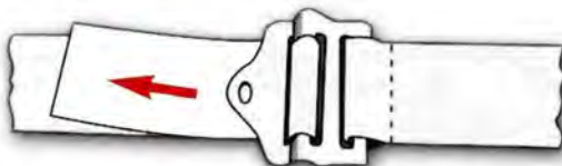
Figure 8-4 - Enfilage d'une boucle autobloquante
