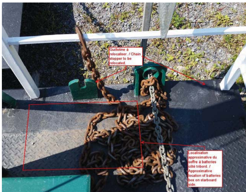
Photo 5 : Zone d'installation du coffre à batteries tribord.
