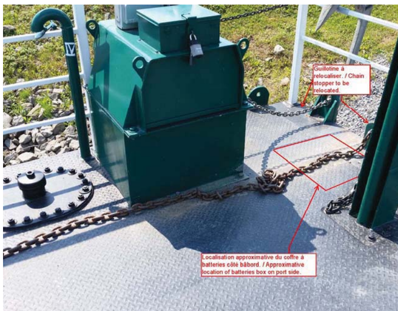
Photo 4 : Zone d'installation des coffres à batteries bâbord.
