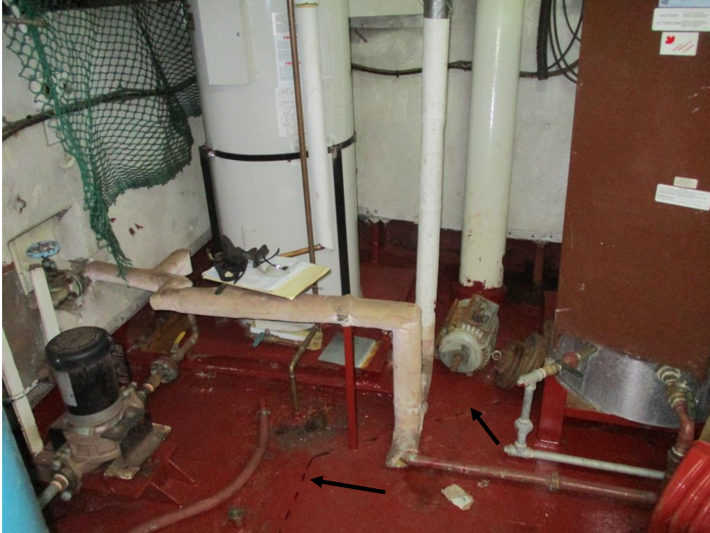
Photo n°7 : Vue générale de la salle des machines auxiliaires – Noter les éléments faisant obstacle. Les flèches indiquent les lignes de coupe
