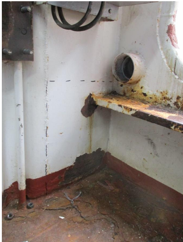
Photo n° 2 : Vue de la cloison transversale dans la salle de CVC. La zone doit être renouvelée comme il est indiqué.
