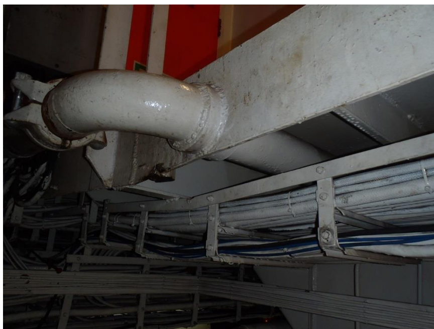
Tuyau de ventilation des eaux usées dans la salle des machines de bâbord qui relie le raccord Roust-A-Bout et la cloison du compartiment des eaux usées de bâbord
