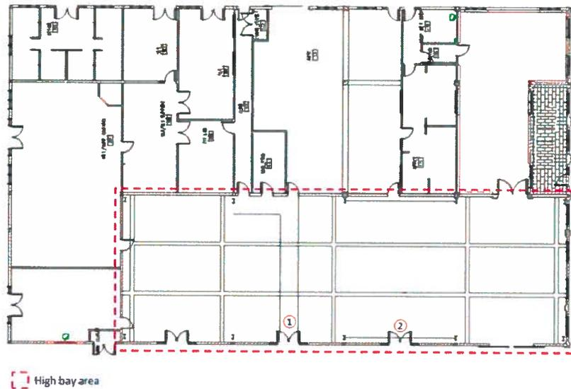
Enlever les portes d'accès existante à l'opposé des nouvelles baies de véhicule et des laboratoires (1 et 2), conserver le cadre et ajouter deux nouvelles portes pleines grandeur pour permettre l'accès de véhicules venant de l'autre côté du corridor. Les dimensions actuelles des cadres sont adéquates, seules les portes doivent être remplacées.
