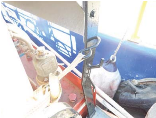
Figure 11: Tribord réservoir de gasoline ejectable
