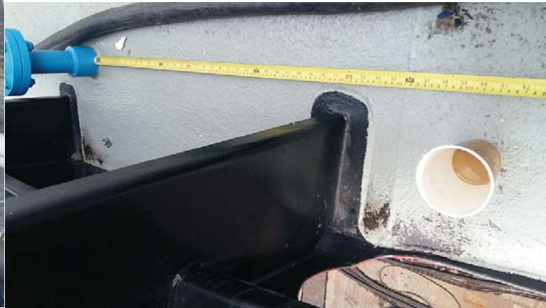
Figure 17: Distance entre l'évent et la fin du réservoir, tel que vu sur le pont principal
