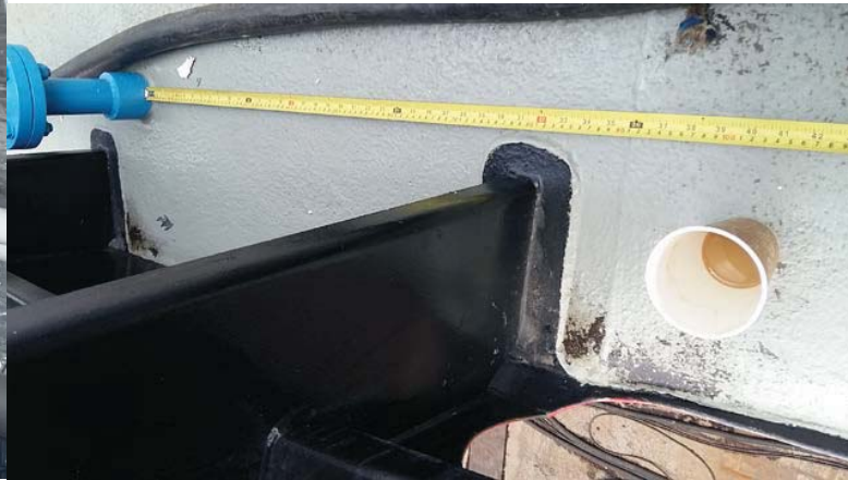
Figure 4: Distance entre l'évent et la fin du réservoir. tel que vu sur le pont principal
