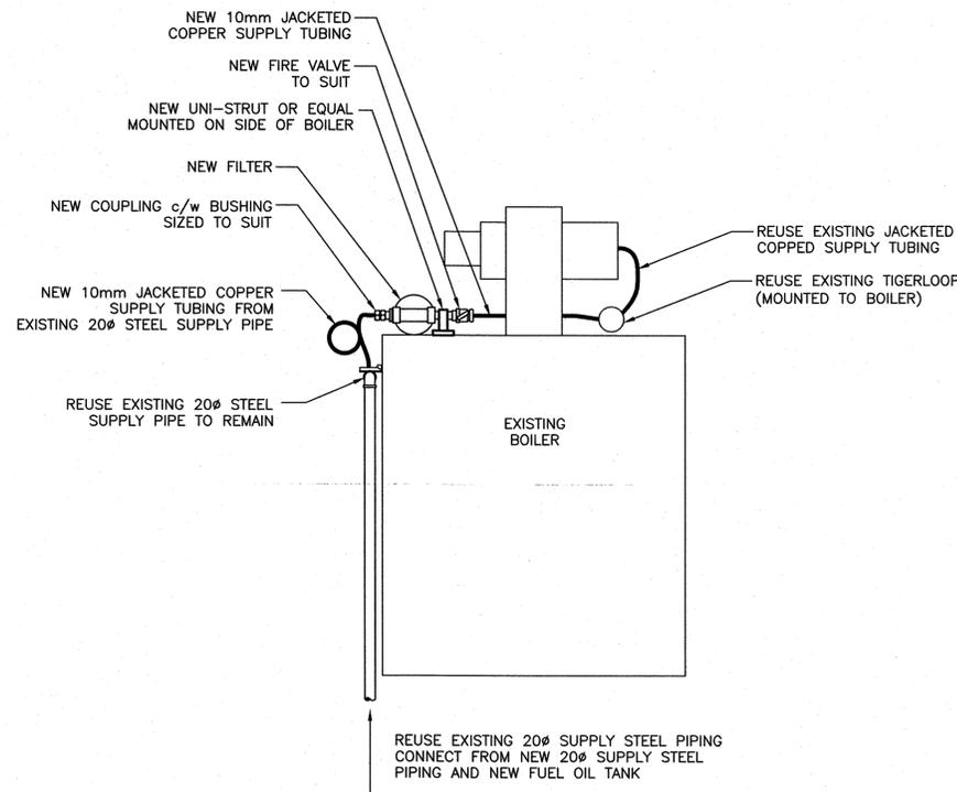
**NEW BOILER CONNECTION PLAN 1**
