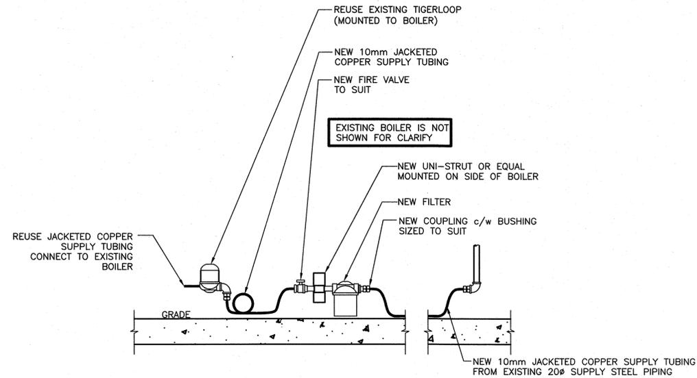
**NEW BOILER SUPPLY CONNECTION ELEVATION 2**
