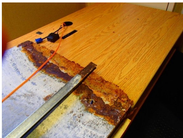
Figure 13 : Bas de panneau Joiner corrodé
