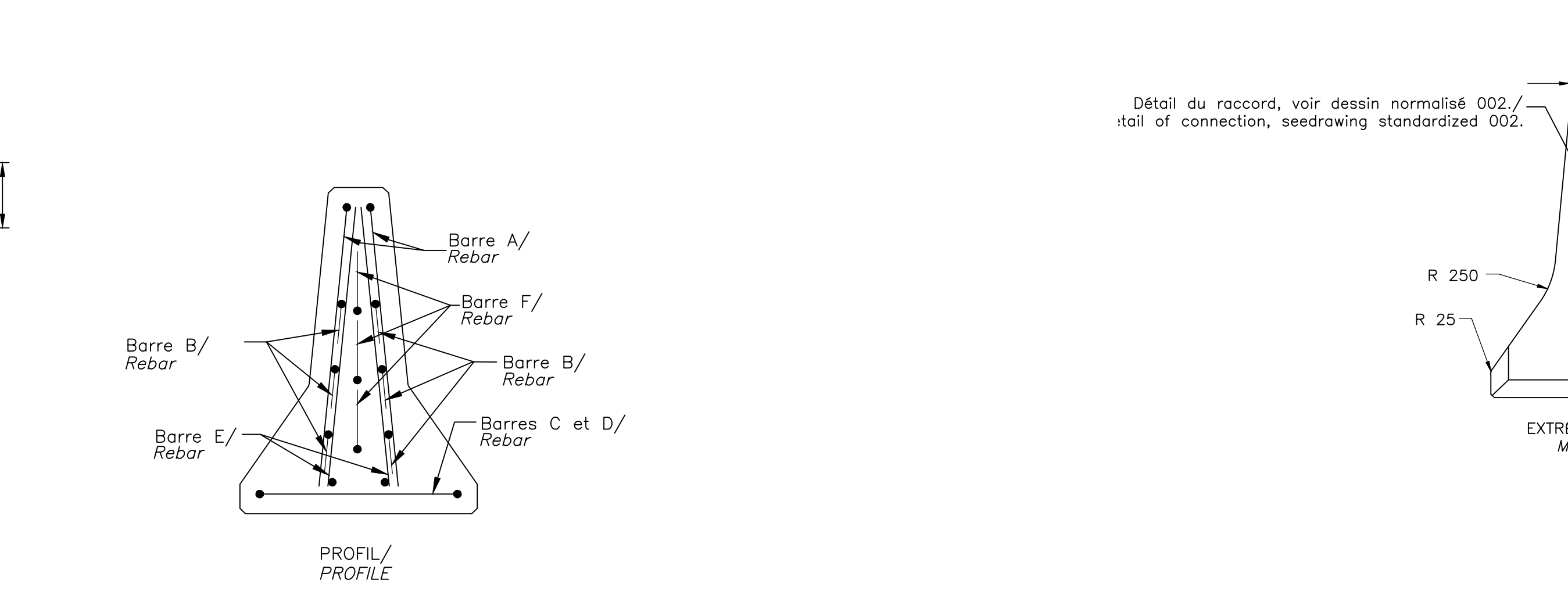
DÉTAIL TYPE - GLISSIÈRE AMOVIBLE EN BÉTON POUR CHANTIER TYPICAL DETAIL - MOVABLE CONCRETE GUARDRAIL ÉCHELLE: AUCUNE NO: SCALE
