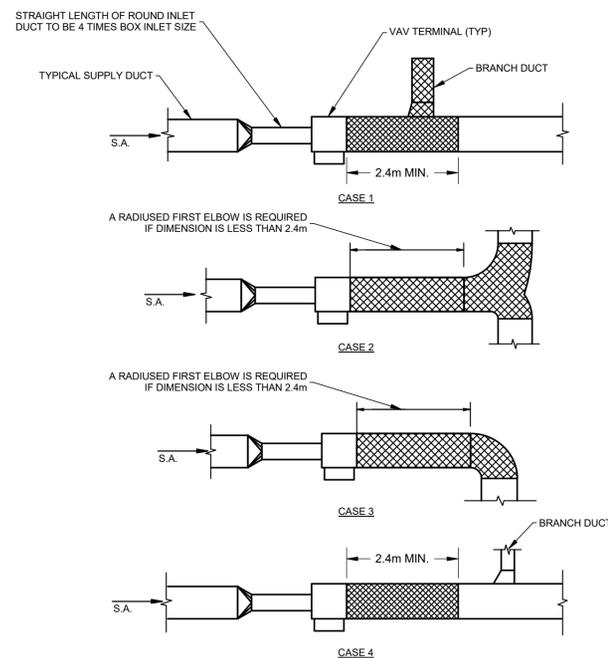
**VAV TERMINAL ACOUSTIC INSULATION**
