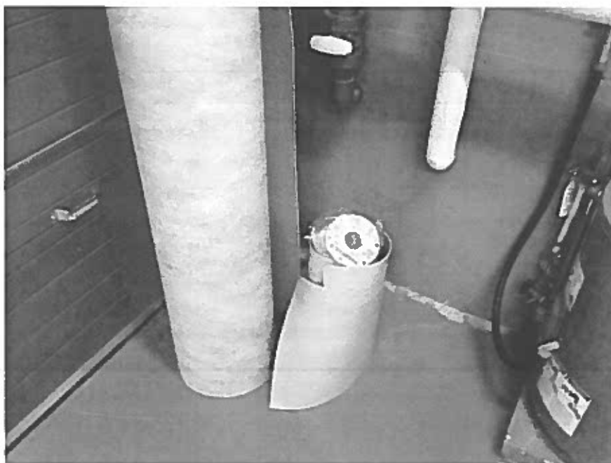
Photo 6 – Rez-de-chaussée – Linoléum orange et linoléum orange et brun, sans amiante, #1 et #2
