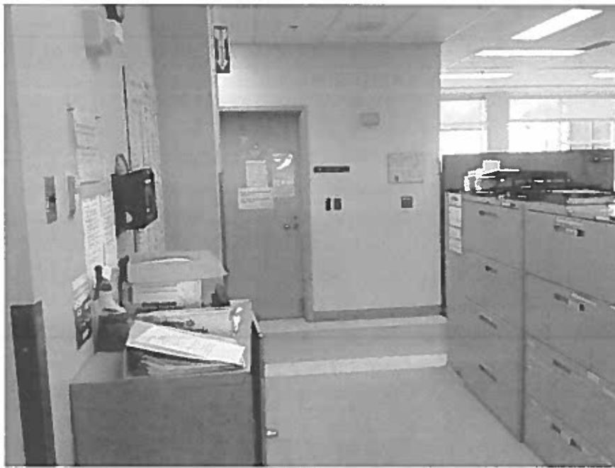
Photo 29 – Locaux I-138, I-135 I-113, I-109, I-107, I-137 – Rez-de-chaussée – Composé à joint sur placoplâtre sur mur et plafond, sans amiante, #4-A à 4-I
