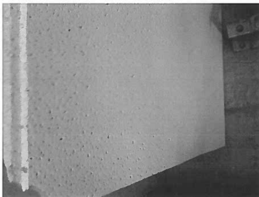
Photo 32 – Local I-222 – 2 e étage – Tuile acoustique 2'X4' avec petits points (entreposée), sans amiante, #2
