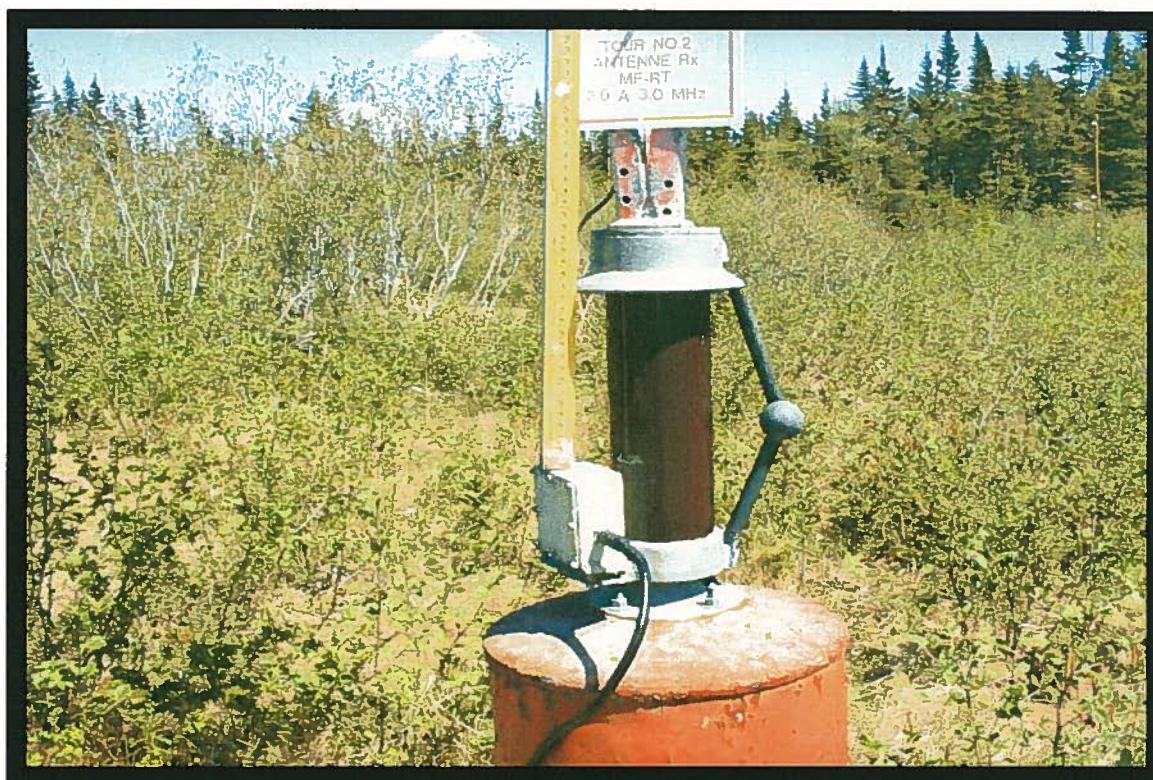
PHOTOGRAPHIE # 11: Vue du repère de nivellement utilisé dans le cadre des travaux.
