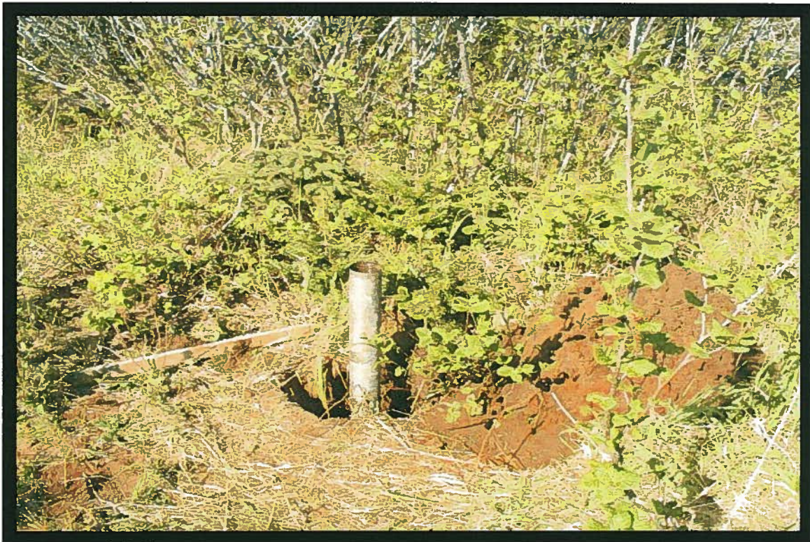
PHOTOGRAPHIE # 5: Excavation manuelle effectuée au sondage F-1 jusqu'à 1,50 m de profondeur.
