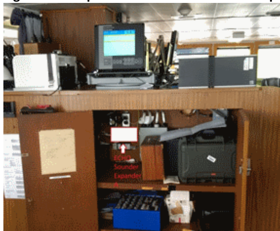
Figure 13 : Emplacement de l'unité électronique Naviknot
