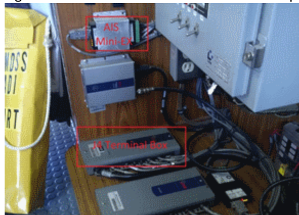
Figure 11 : Boîte à bornes J4 de l'AIS et mini-expandeur
