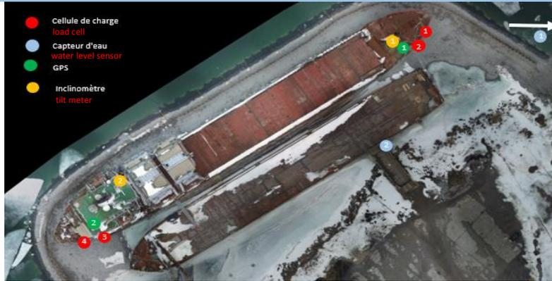
**Inclinomètre / Tilt meter**
