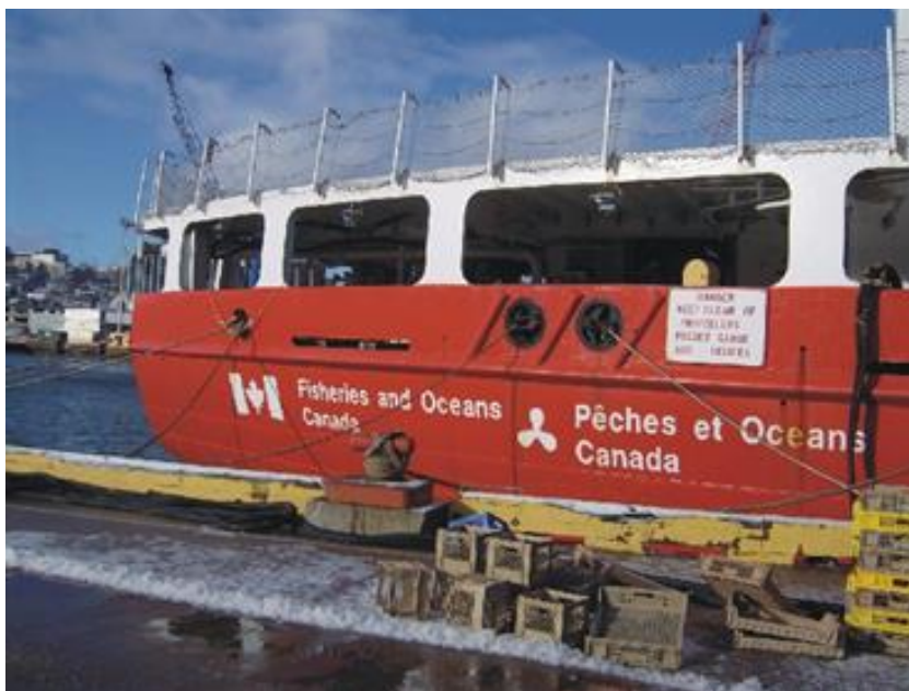
Le périmètre de l'hélicoptère sur les navires est délimité par une clôture qui empêche les chutes
