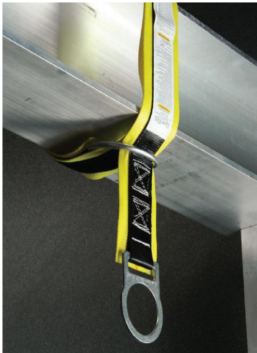
Poutre utilisée comme ancrage non désigné
