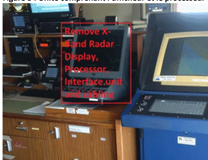
Figure 3 : Unité comprenant l'afficheur et le processeur du radar en bande X
