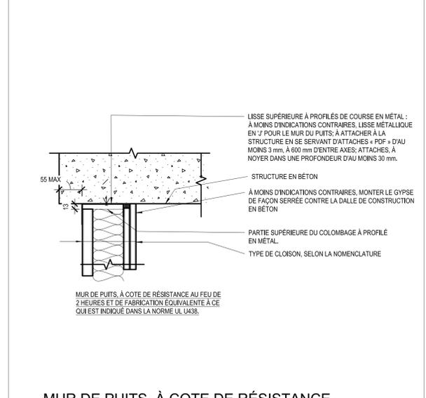
**9** MUR DE PUIITS, À COTE DE RÉSISTANCE - STRUCTURE EN BÉTON
