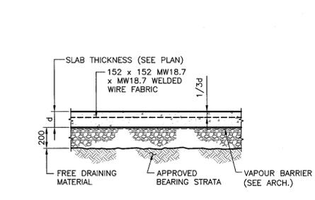
**DETAIL - TYPICAL SLAB ON GRADE**
