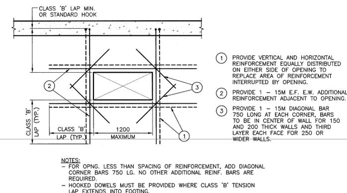
**DETAIL - TYPICAL REINFORCING AT RECTANGULAR OPENINGS**
