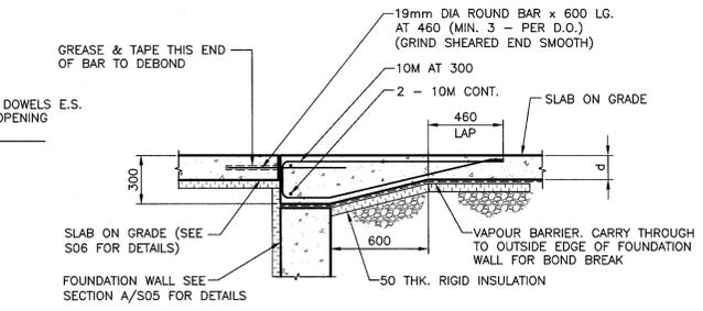
**DETAIL - TYPICAL ISOLATION JOINTS**
