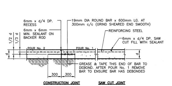
**DETAIL - TYPICAL CONTROL JOINT (C.J.) (SEE PLAN)**
