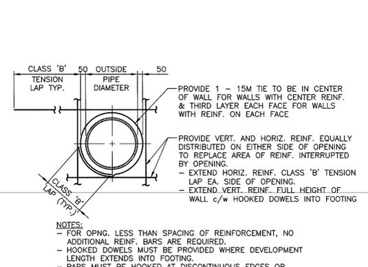
**DETAIL - TYPICAL REINFORCING AT ROUND OPENINGS**
