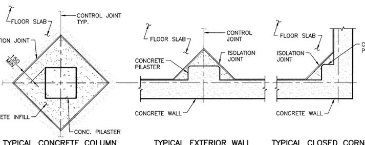
**DETAIL - TYPICAL PILASTER ISOLATION JOINTS**
