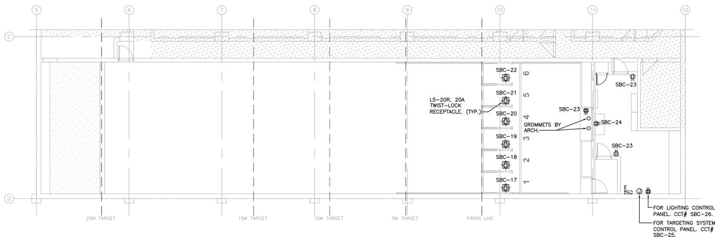
**1** PARTIAL ELECTRICAL SUB-BASEMENT – NEW POWER PLAN
