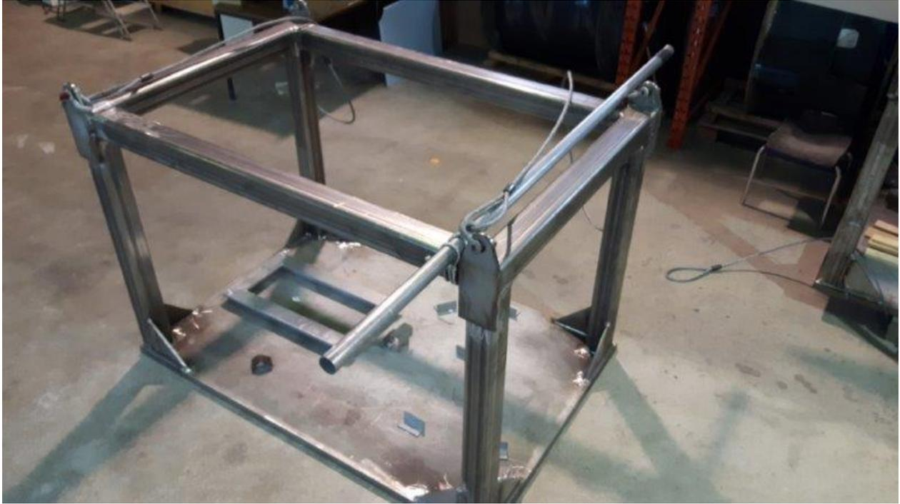
Figure 1.4-2 : Traîneau de déploiement avec alimentation électrique et transmetteur de données
