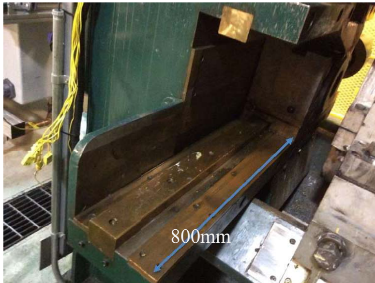
Figure 6. Longueur de la course du système d'insertion de la filière.
